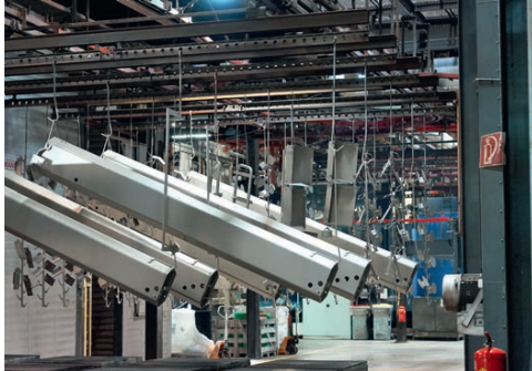
Die Bauteile werden mechanisch durch Strahlen, Abblasen und anschließend nasschemisch gereinigt. Fotos: Redaktion; Jochen Kratschmer
