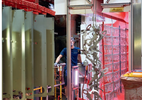
Die Anlagentechnik, hier die Pulverbeschichtung, ist für eine hohe Variantenvielfalt ausgelegt.
