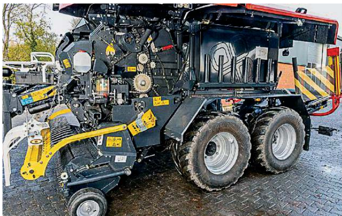
Na ľavej strane sa nachádza reťazový pohon, zásobník centrálného mazania a priestor pre 12 balov fólie. Na pravej strane sa nachádzajú hydraulické komponenty.
