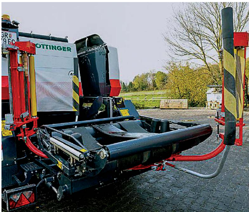
Obaľovačka pracuje plynulo. Paralelogramovo sa prispôsobuje na rôzne priemery balíkov.
