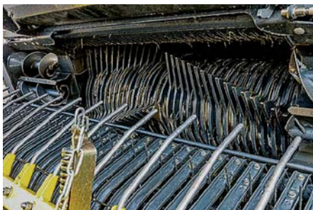
Hmota ide cez zberač s vodiacim valcom a dvoma stranovými závitovkami a ponad rotor. Vniká bezproblémovo a plynulo.
