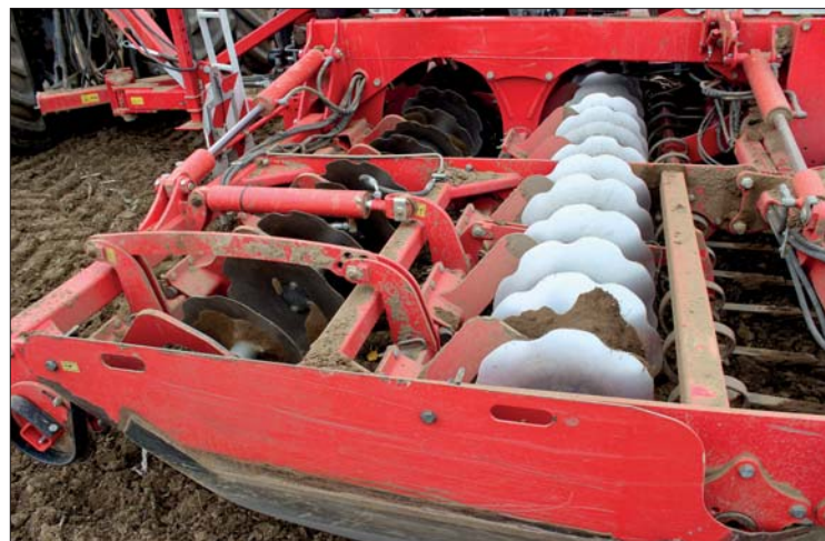
Předřazená sekce krátkých talířových bran u secího stroje Pöttinger Terrasem C6 dovoluje přímo po orbě přistoupit k setí do hrubé brázdy – a to i u trav. V případě potřeby je možné talíře první řady nastavit do větší pracovní hloubky
