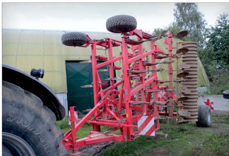
Radličkový kypřič Synkro 6030 T Nova se využívá ke kypření půdy do hloubky 20 až 25 cm. Je vybaven úzkými radličkami, pružinovým nonstop jištěním proti přetížení a gumovým válcem
