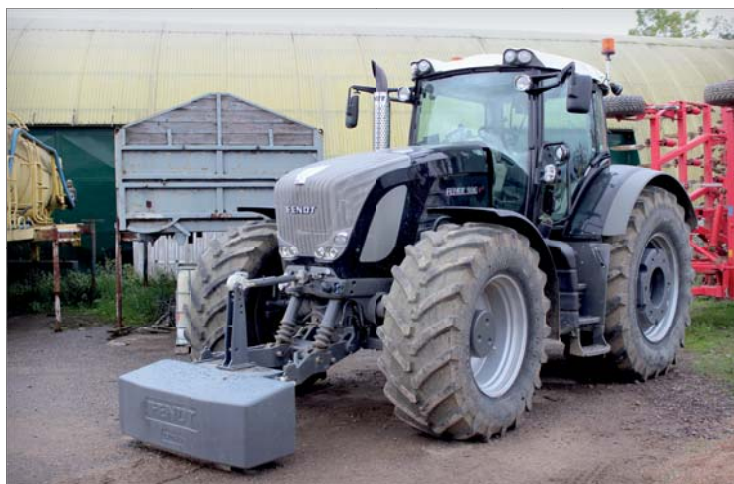
Traktor Fendt 936 Vario se při základním zpracování půdy s otočným pluhem či radličkovým kypřičem Synkro 6030 T Nova ukázal jako velmi úsporný. Kypření do hloubky 20 až 25 cm zvládá při spotřebě 11 až 12 litrů na hektar, orbu za 12 až 16 litrů na hektar
