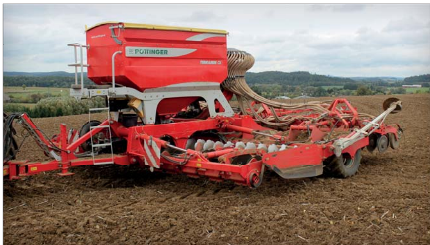
Pneumatický secí stroj Terrasem C6 si poradí s přípravou setového lůžka jak po radličkovém kypřiči, tak i po orbě. Rozdíl ve spotřebě paliva je pouhý jeden litr nafty: při setí do podmytky činí sedm litrů a při setí po orbě osm litrů na hektar
