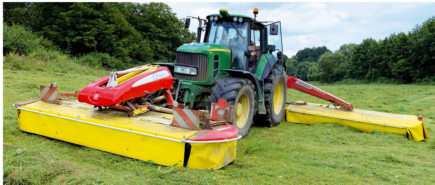
Žací kombinace NOVACAT S10 s čelní lištou NOVACAT 351 F ALPHA MOTION dokáže v agregaci s traktorem 200 k za den sklízet 80 až 100 hektarů.
