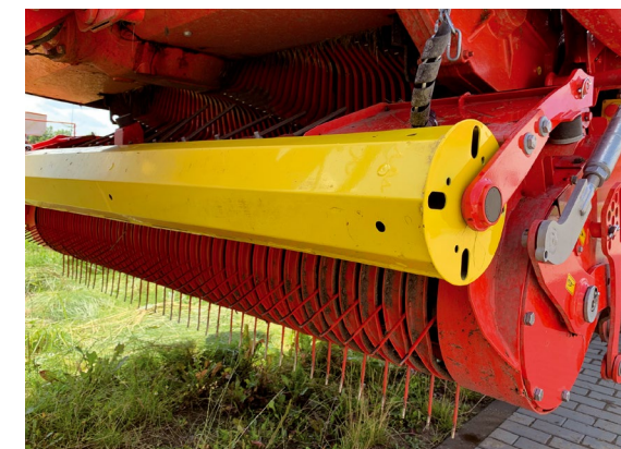
Porovnání sběracího ústrojí u vozu JUMBO 6600 L (na horním snímku), který má za sebou dvacet sezon, s novým senážním vozem JUMBO 8020 L. Prsty nového sběrače s výkyvným uložením jsou při kontaktu s pozemkem jen minimálně zatíženy, takže píci neznečišťují a sbírají velmi šetrně.
