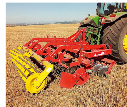
Diskový podmiťáč TERRADISC 4000 (na snímku) využívají na farmě od roku 2010 a každoročně s ním podmiťají celou výměru po sklizni řepky a obilovin. Dělá také přípravu před setím pro jarní plodiny. V agregaci s traktorem 320 k pracuje rychlostí kolem 15 km/h do hloubky kolem 8 cm. Od letošního srpna jsou vlastníky diskového podmiťáče TERRADISC 6001 T.
