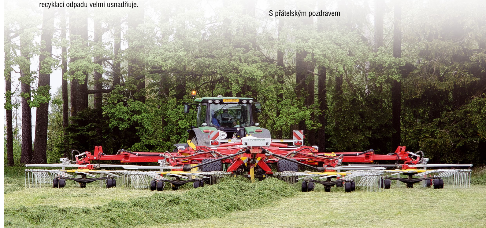
Čtyřrotorový středový shrnovač TOP 1403 C s maximálním záběrem 14 metrů při sklizni senáže ve VOD Jetřichovec na Táborsku.
