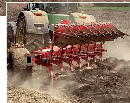
Osmiradličný pluh SERVO 6.50 PLUS NOVA ročně zpracuje v agregaci s traktorem 350 k při jarní a podzimní orbě asi 400 hektarů. Většinou do hloubky kolem 25 cm, s denní výkonností 15 až 20 hektarů a při spotřebě 15 až 17 litrů nafty na hektar.
