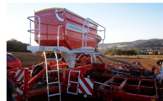
Šestimetrový univerzální secí stroj TERRASEM C6 ARTIS seje kromě kukuřice všechny plodiny včetně přísevu a obnovy trvalých travních porostů.
