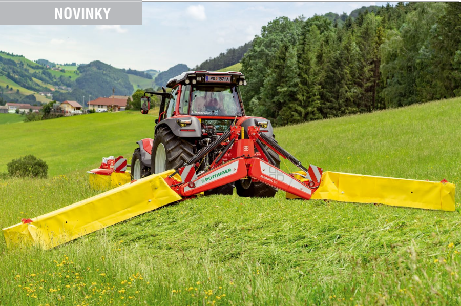
Především při nerovných a příkrých plochách je velký rozsah výkyvu žacích jednotek výhodou (od +22 do -30 stupňů). Na snímku je nízkoenergetická žací kombinace NOVADISC 812.
