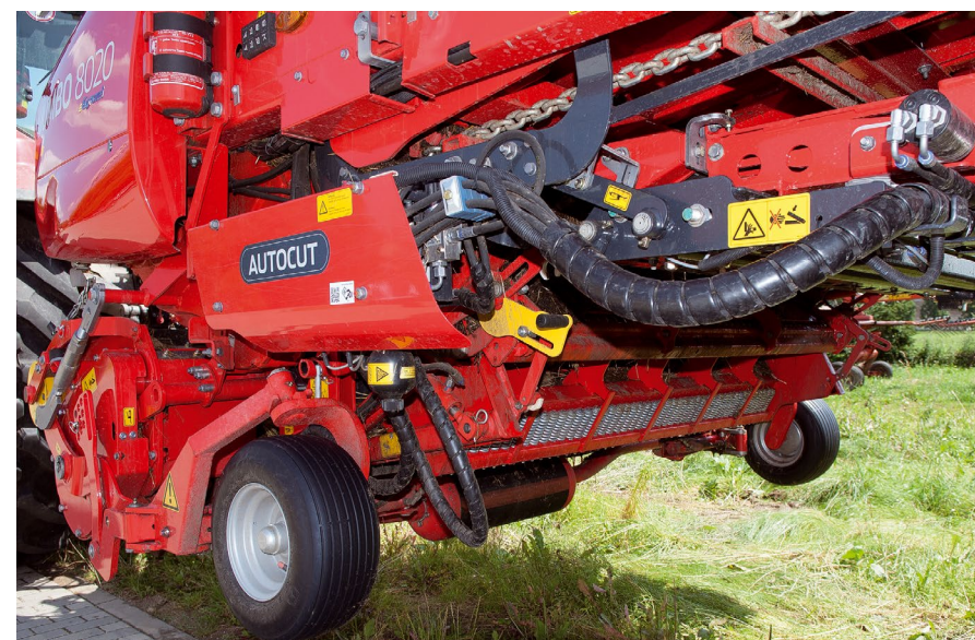
Automatická bruska AUTOCUT u vozu JUMBO 8020 L zajistí ostré nože pro dosažení nejlepší kvality řezanky. Obsluha kladně hodnotí sběrač s šířkou 2,30 metru, hydraulickým odlehčením a středovým opěrným válečkem.
