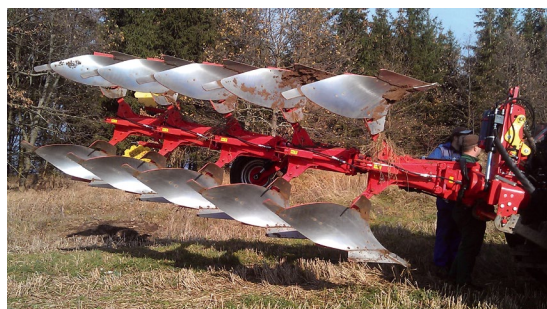
Nesený pětiradličný pluh SERVO 45 S PLUS NOVA bude mít letos za sebou deset sezon. Vybavený je NONSTOP jištěním a hydraulicky nastavitelným pracovním záběrem pro přizpůsobení se aktuálním půdním podmínkám. S traktorem 240 koní ročně zpracuje kolem 500 hektarů do hloubky 20 až 25 cm.
