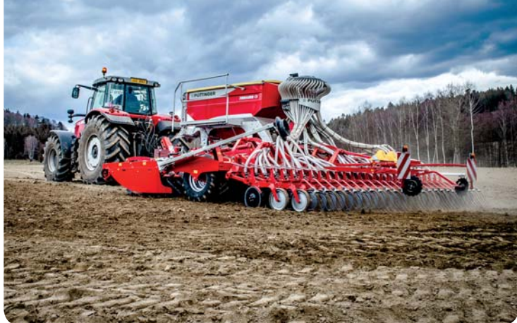
Univerzální secí stroj Terrasem C6 je vybaven dvouřadým talířovým podmiřákem, pneumatikovým válcem a nosníkem dvoudiskových btek Dual Disc. Proveďte předseťovou přípravu půdy, vytvoří seťové lůžko, uloží osivo a zpětně půdu utuží
