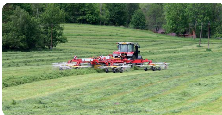
Eurotop 1252 C vytváří na hmotu bohaté řádky, rotory velmi dobře kopírují terén a píce je bez příměsí
