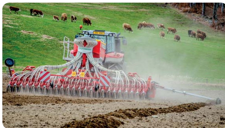
Secí stroje Terrasem lze použít v různých technologiích, od orby přes seť do mulče až po seť do strniště
