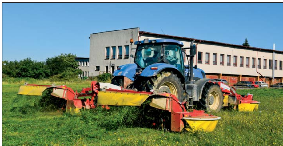
Žacia kombinácia Pöttinger NOVACAT X8 s pracovným záberom 8,3 m. K výbave patrí kondicionér a zhadzovacie pásy, ktoré je možné jednoducho demontovať.
