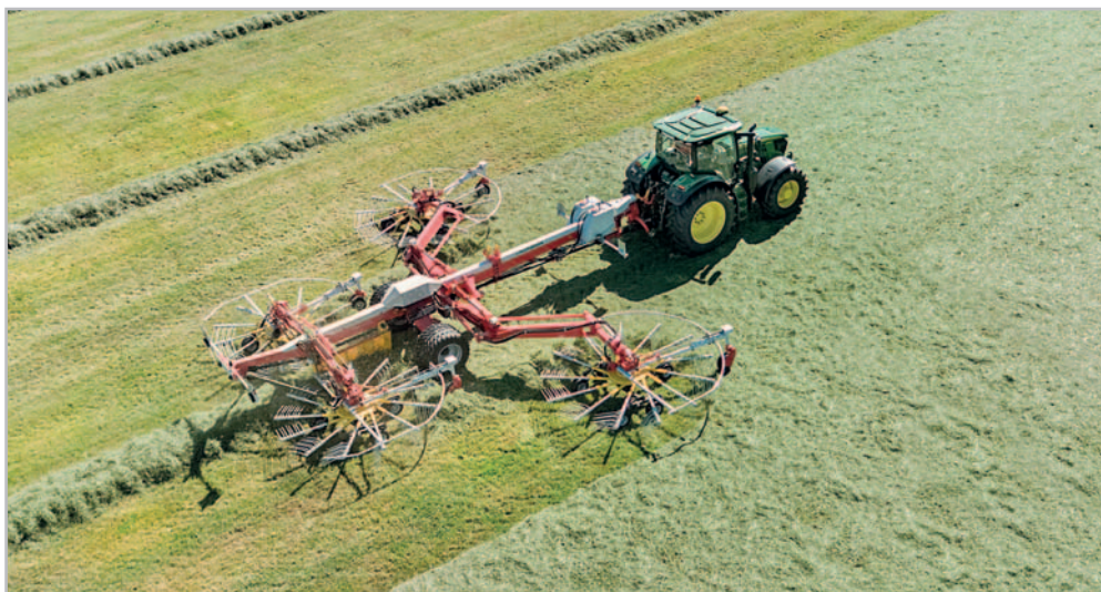
Další novinkou firmy Pöttinger pro rok 2021 je čtyřrotorový shrnovač TOP 1403 C s maximálním pracovním záběrem 14 m. Kromě hybridního pohonu jsou i oba přední rotory odlehčovány hydraulicky a zadní pak mechanicky
