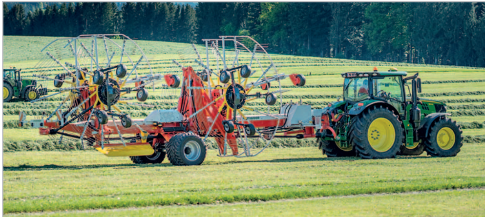
I přes enormní pracovní záběr má shrnovač TOP 1403 C v transportní poloze šířku do tří metrů a výšku do čtyř metrů
