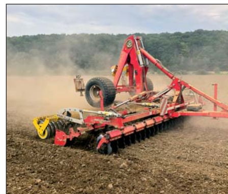
Diskové náradie Pöttinger Terradisc 6001 je možné použiť univerzálne na podmietky a predsejbovú prípravu pôdy na jar alebo jeseň.
