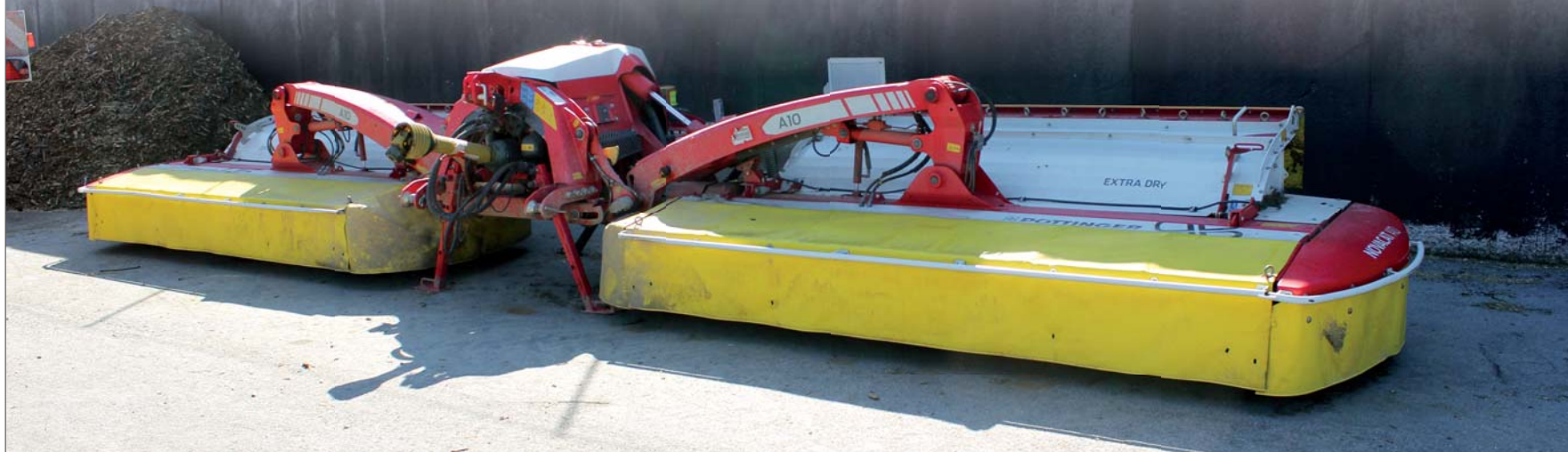
Od jara 2019 pracuje ve VOD Jetřichovec žací kombinace Pöttinger NovaCat A10. Je vybavena hydraulicky ovládaným stranovým posunutím, centrálním mazáním a ovládaním Power Control
