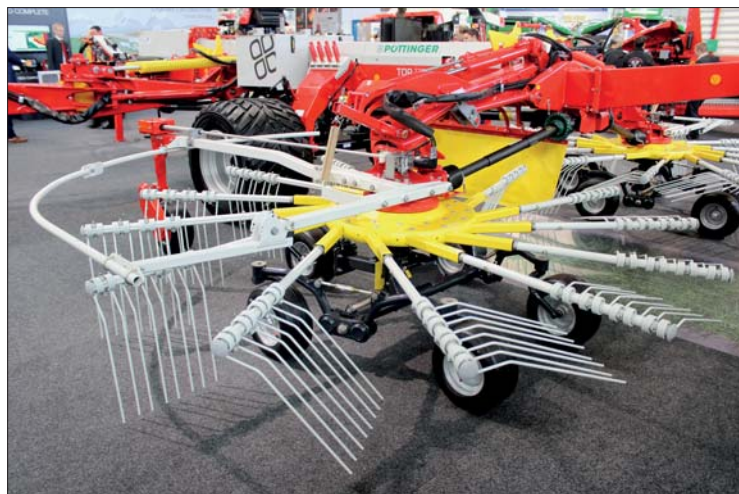
Rotory Toptech Plus se díky velkému rozestupu mezi ložiskem a hrabicemi vyznačují velkou stabilitou. Uložení ramen je bezúdržbové a rameno hrabic lze snadno demontovat
