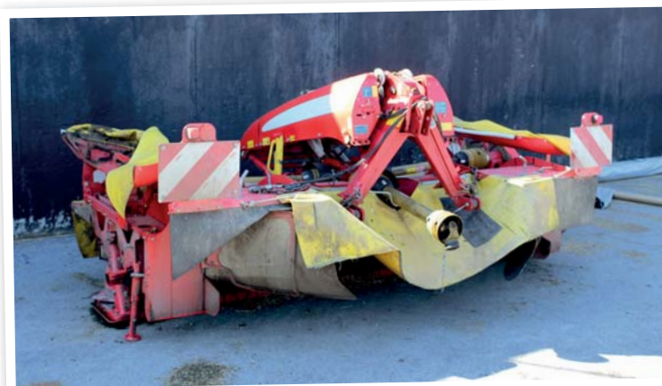
Čelně nesený žací stroj NovaCat 301 F ED alpha motion dokáže rovnoměrně kopírovat povrch pozemku i při vyšších jezdových rychlostech. Je to dáno unikátní konstrukcí závěsu alpha-motion, který se pohybuje se žacím strojem jako celek
