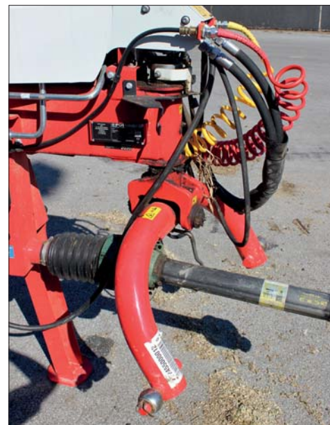
V závěsu shrnovače TOP 1403 C se nachází senzory a rozvaděče, díky čemuž je při zatáčení přední rotor uvnitř zatáčky automaticky posouván směrem dovnitř. Tím je zaručena dostatečná úroveň překrývání zadními rotory shrnovače
