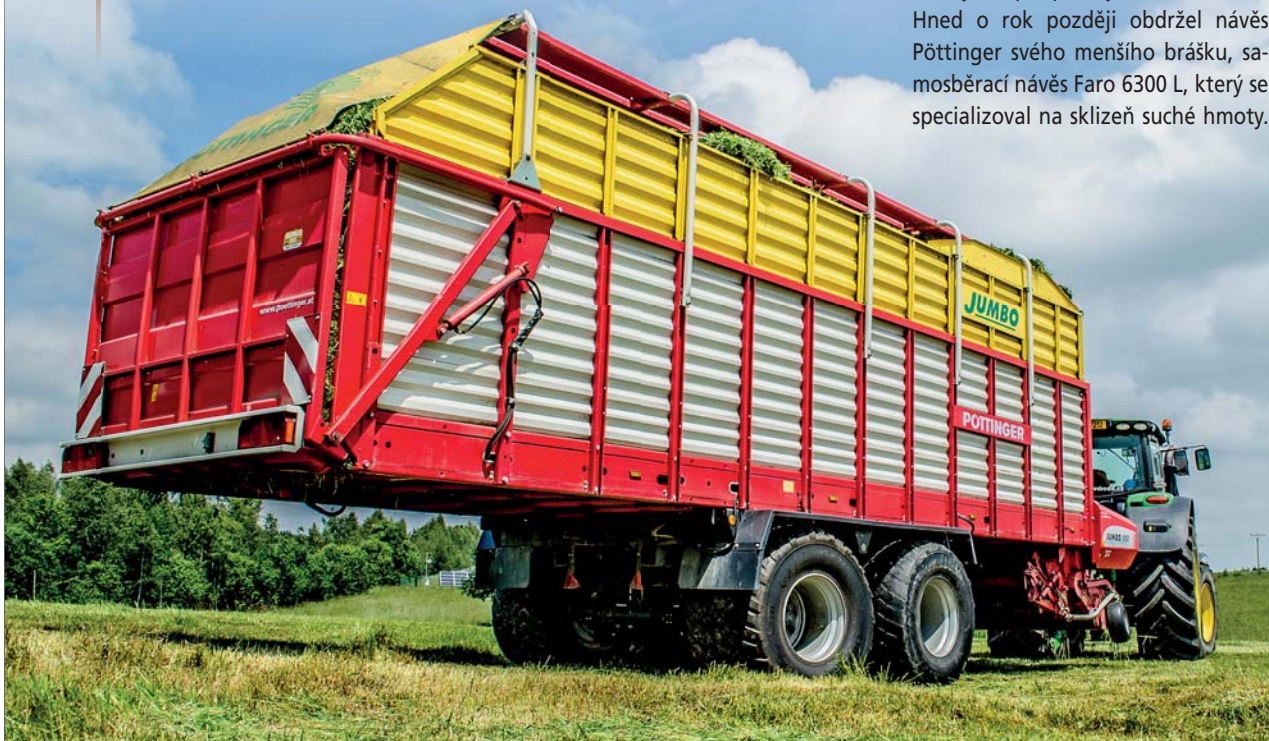
Senážní návěs Pöttinger Jumbo 8000 L překvapil svou výkonností při velmi jednoduché organizaci práce a značné flexibilitě. Sklízal travní senáže z luk, z porostů na orné půdě, odvázel kukuřici od řezačky a také suchou hmotu
