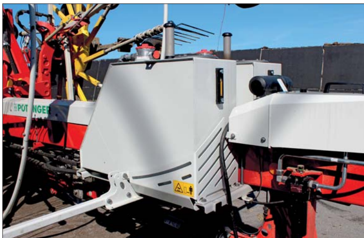
TOP 1403 C disponuje hybridní technologií pohonu, osvědčenou již u předchůdců: přední dva rotory jsou poháněny hydraulicky a zadní mechanicky. Vlastní palubní hydraulický systém využívá tyto dostatečně dimenzované nádrže na olej
