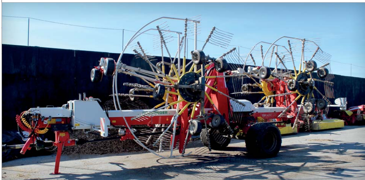
Tam, kde dříve byly zapotřebí shrnovače dva, stačí nyní jeden – tento zbrusu nový model firmy Pöttinger s označením TOP 1403 C. Při maximálním vysunutí předních rotorů má pracovní záběr rovných čtrnáct metrů, nejmenší záběr pak činí devět metrů
