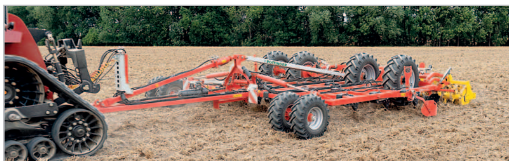
Větší provedení radličkových kypřičů Terria se čtyřmi řadami radliček mohou vyžadovat tažený prostředek o výkonu až 600 k Foto archiv
