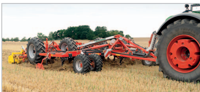
Tažené radličkové kypřiče nové řady Terria firmy Pöttinger se vyznačují moderní konstrukcí. Integrovaný podvozek snižuje poloměr otáčení, přední opěrná kola zaručují udržování pracovní hloubky na nastavené úrovni a k dispozici je také nový systém hydraulického non-stop jištění s vypínací silou 650 kg Foto archiv
