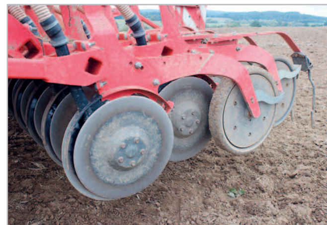
Dvojkotoučové secí botky Dual Disc jsou tvořeny dvojicí kotoučů v mírném přesazení a opěrným a utužovacím kolečkem. Botky tvoří úzký žlábek bez rostlinných zbytků
