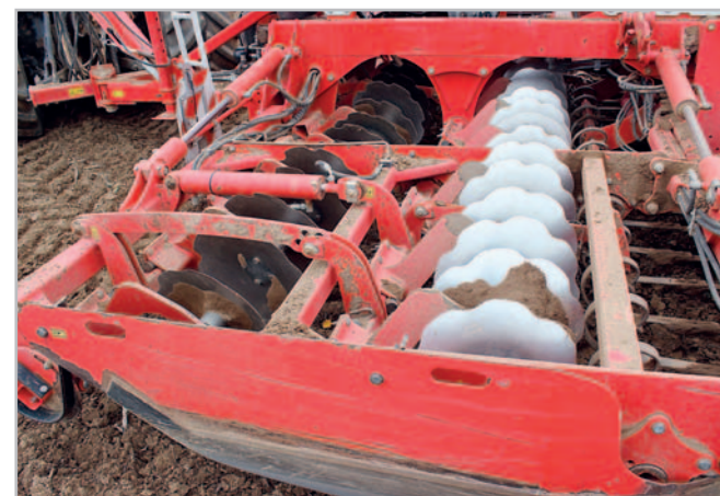
Předřazená sekce krátkých talířových bran u secího stroje Pöttinger Terrasem C6 dovoluje přímo po orbě přistoupit k setí do hrubé brázdy – a to i u trav. V případě potřeby je možné talíře první řady nastavit do větší pracovní hloubky
