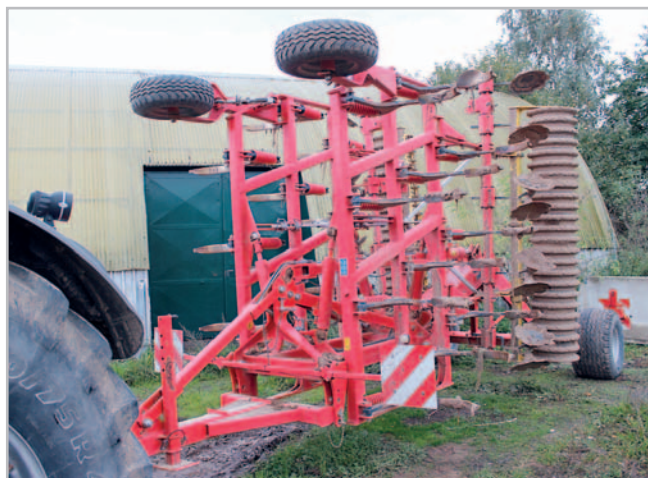
Radličkový kypřič Synkro 6030 T Nova se využívá ke kypření půdy do hloubky 20 až 25 cm. Je vybaven úzkými radličkami, pružinovým non-stop jištěním proti přetížení a gumovým válcem
