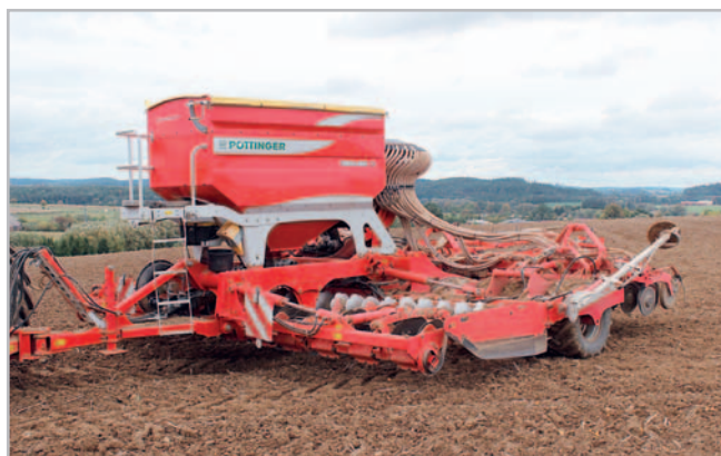
Pneumatický secí stroj Terrasem C6 si poradí s přípravou setového lůžka jak po radličkovém kypřiči, tak i po orbě. Rozdíl ve spotřebě paliva je pouhý jeden litr nafty: při setí do podmítky činí sedm litrů a při setí po orbě osm litrů na hektar
