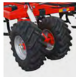
Hydraulicky ovládaná dvojitá čelní kola 11,5/80-15,3
