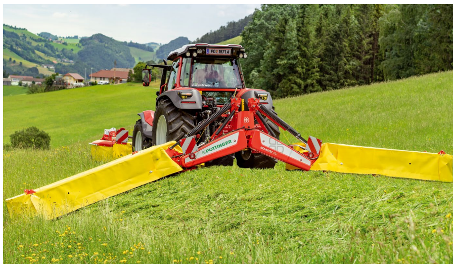
Především při nerovných a příkrých plochách je velký rozsah výkyvu žacích jednotek výhodou (od +22 do -30 stupňů). Na snímku je nízkoenergetická žací kombinace NOVADISC 812.
