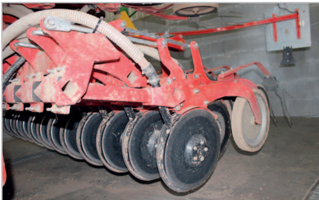
Dvoukotoučové secí botky Dual Disc s pryží potaženými opěrnými kolečky udržují hloubku setí na nastavené úrovni. Jejich uchycení prostřednictvím gumových tlumičů je bezúdržbové Foto Petr Beneš
