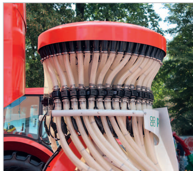
Rozdělovací hlavu IDS secích strojů Terrasem vidí Miroslav Šolc jako jejich velkou přednost. Do budoucna uvažuje o změně rozteče řádků při setí ozimé řepky z 12,5 na 25 cm Foto Petr Beneš
