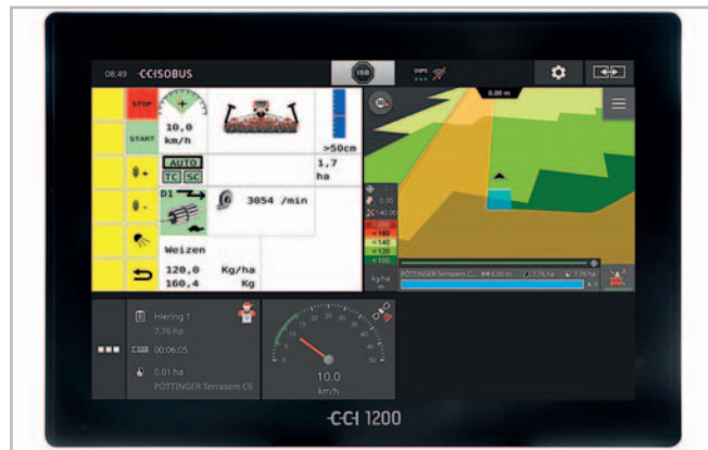
K ovládání secího stroje Terrasem C6 je možné využívat ISOBUS terminál CCI 1200. Možné je také setí s lokálně variabilní výší výsevku v rámci systému Seed Complete Foto archiv
