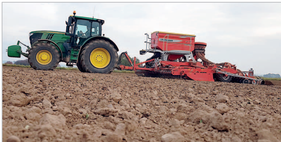
Pneumatický secí stroj Terrasem C6 firmy Pöttinger si poradí i s hrudovitou strukturou půdy Foto archiv
