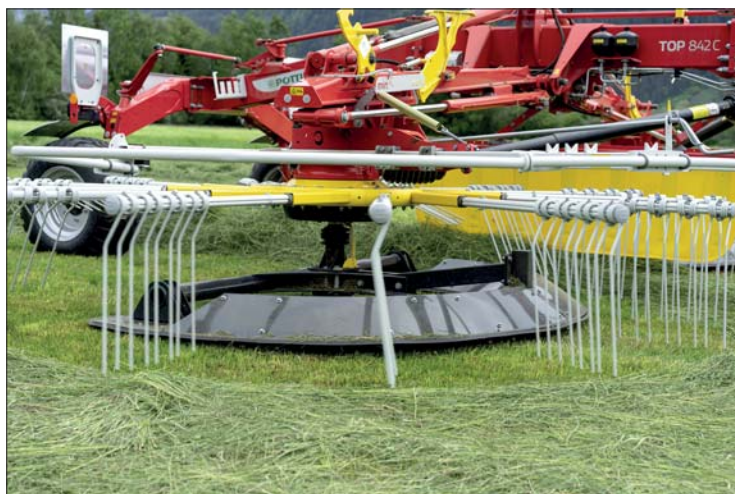
Nový plaz Flowtast snímá povrch pozemku v celém pracovním rádiu prstů – v těsné blízkosti jejich dráhy
