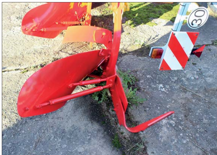
V případě, že je velký polonesený otočný pluh agregován s traktorem, obutým do širokých pneumatik, je možné poslední orební tělesa doplnit o rozšiřovač brázdy
