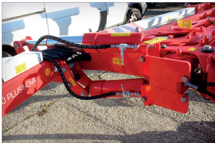
Plynulé otáčení hlavního rámu s orebními tělesy i v plné výbavě zajišťuje dvojice silných teleskopických pístnic
