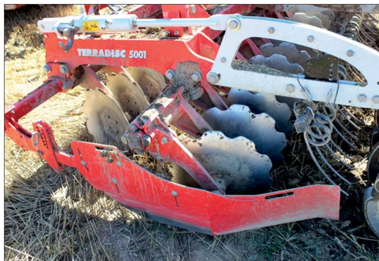
Podmítač Terradisc 5001 T se v praxi ukázal jako stroj s velmi dobrou průchodností jednak díky konceptu otevřeného rámu, jednak pro vhodné uchycení talířů. Sekce prutů za druhou řadou talířů vrací uvolněný materiál zpátky na povrch pozemku
