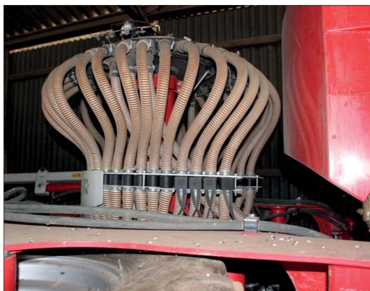
Obsluha traktoru má také neustálý přehled o průchodnosti semenovodných hadic, které jsou opatřeny senzory průchodnosti
