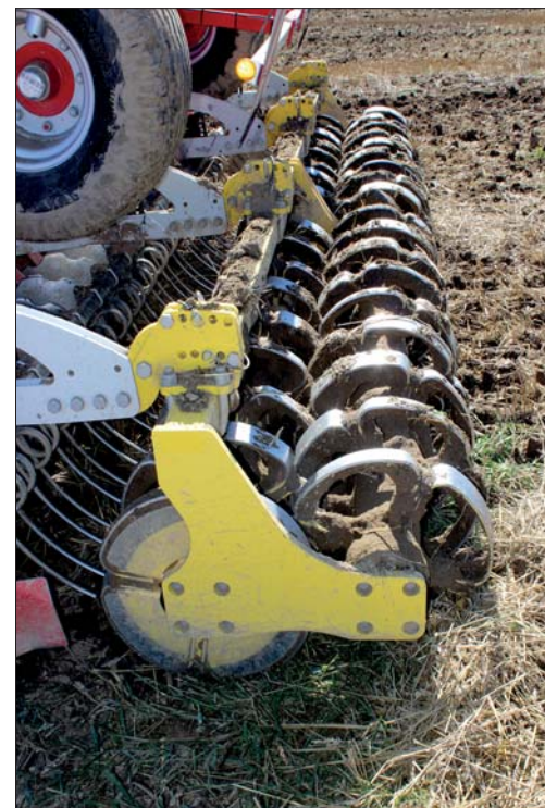
Díky samočisticímu efektu má zdvojený válec Tandem Conoroll velkou odolnost vůči zalepování
