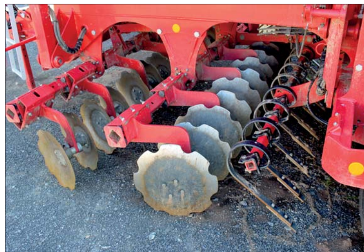
Sekce talířů o průměru 510 mm ve dvou řadách zajišťuje u secích strojů Terrasem obnovu struktury půdy. Před pneumatikovým válcem je povrch pozemku urovnáván ještě hydraulicky nastavitelnou smykovou lištou
