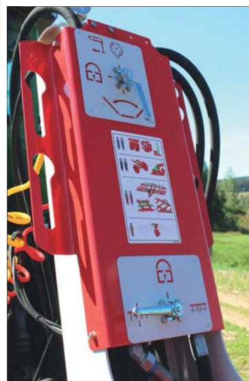
Vpředu na držáku hydraulických hadic je přehledný panel s kohouty pro ovládání hydraulických funkcí. Kohoutem nahoře se nechá zvolit nastavení tlaku v systému, jištění, uzamknout stroj pro dopravu, aktivovat rozložení do pracovní polohy a složení do polohy transportní; spodním kohoutem se pak aktivuje nastavení opěrného válce a sekce nivelačních talířů
