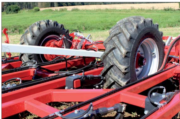
Terria má svůj podvozek integrovaný do pracovního pole. Z toho pramení předností, jako jsou kompaktní celkové rozměry a lepší obratnost ve spojení s traktorem na souvratích
