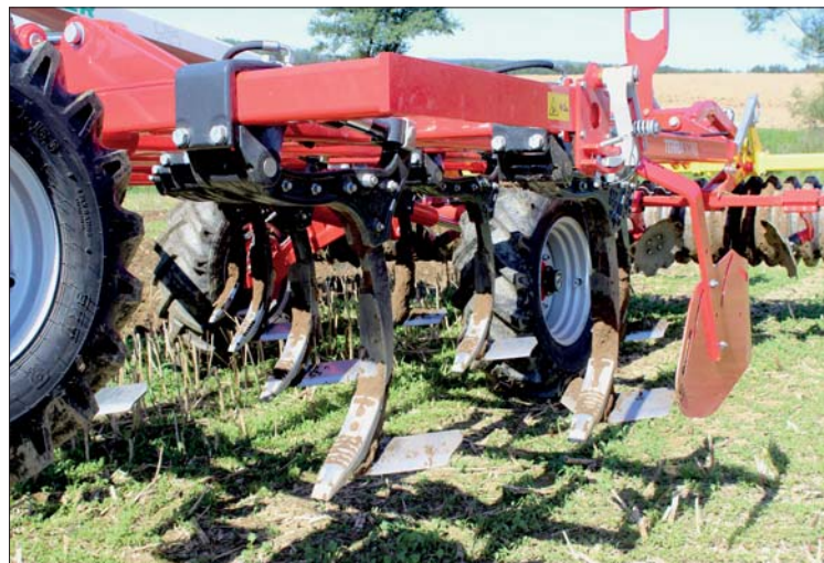
Tvarování radliček a slupic přispívá k intenzitě míchání půdy a posklizňových zbytků. Zároveň má stroj i průchodnost na velmi dobré úrovni, jak potvrzují zkušenosti z VOD Jetřichovec
