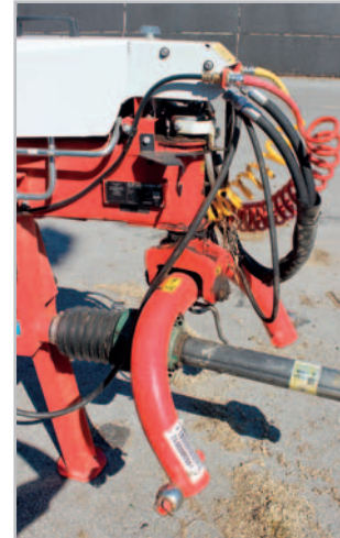
V závěsu shrnovače TOP 1403 C se nacházejí senzory a rozvaděče, díky čemuž je při zatáčení přední rotor uvnitř zatáčky automaticky posouván směrem dovnitř. Tím je zaručena dostatečná úroveň překrývání zadními rotory shrnovače
