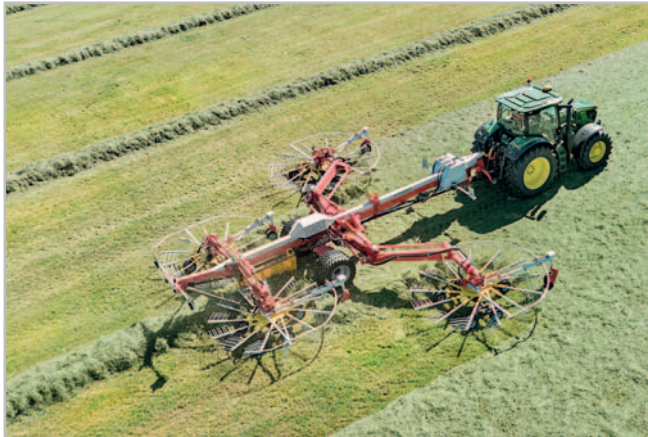
Za den lze se čtyřrotorovým shrnovačem TOP 1403 C zformovat řádky na 80 až 90 ha u luk a až na 110 hektarech v případě sklizně na orné půdě
