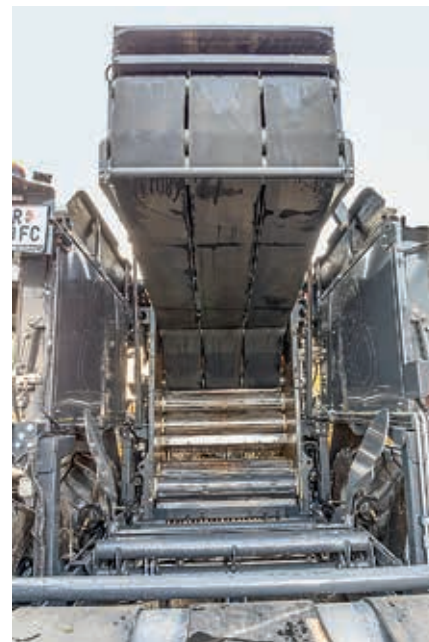
Komora ma cztery walce i trzy pasy, taka geometria daje bardzo małą komorę, która zagęszcza paszę od samego początku.
