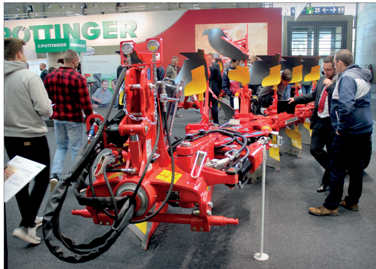
Nesené pluhy nové řady Servo 45 M existují jako čtyř- až šestiradlicné. Rámová konstrukce z mikrolegované jemnozrné oceli je uvnitř přidavně zpevněna dvěma výztuhami
