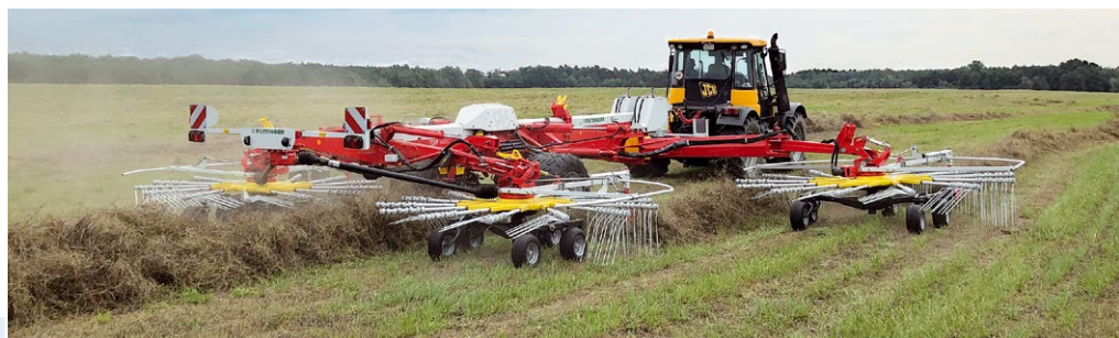
Štvorrotorový zhrňovač TOP 1403 C s pracovným záberom 8,5 až 14 metrov má vysokú výkonnosť, nízku energetickú náročnosť, šetrne manipuluje so zhrňovaným materiálom, takže znečistenie a straty odrolom sú minimálne.
