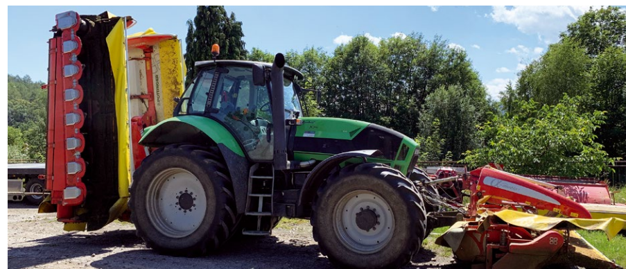
Žací kombinace NOVACAT A10 CF se šnekovými dopravníky a čelní lištou NOVACAT 301 F ED ALPHA MOTION.
