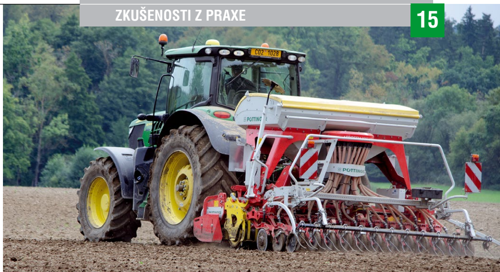
Pneumatický nastavbový secí stroj AEROSEM 3002 ADD je vybavený dvoudiskovými botkami pro uložení osiva do nastavené hloubky a vodicími válečky pro následné utužení.
