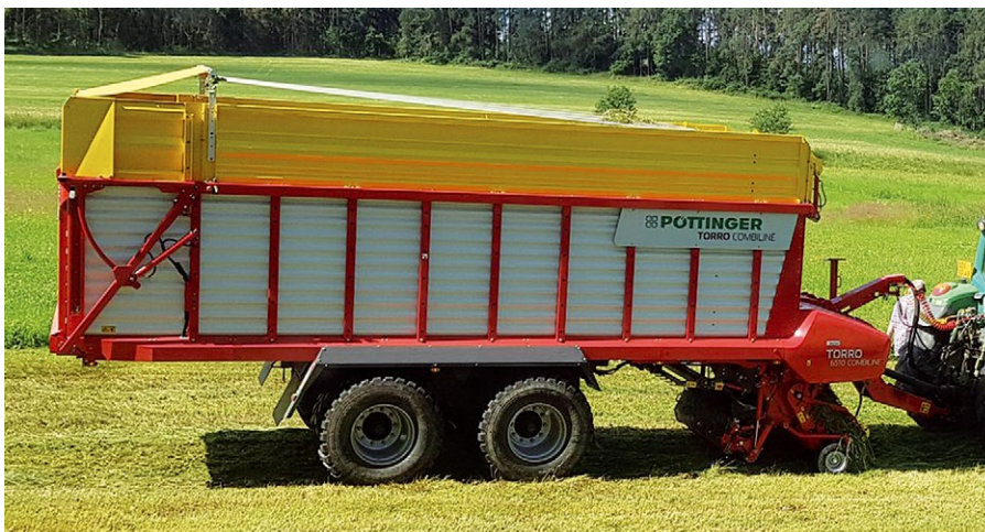
Víceúčelový senážní vůz TORRO 6510 L COMBILINE pořízený minulou sezónou má válcové vkládací ústrojí a je vybavený automatickou bruskou AUTOCUT, která umožňuje broušení nožů během sklizně přímo na vozu.
