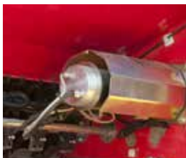
Elektrický pohon dávkovacího ústrojí
