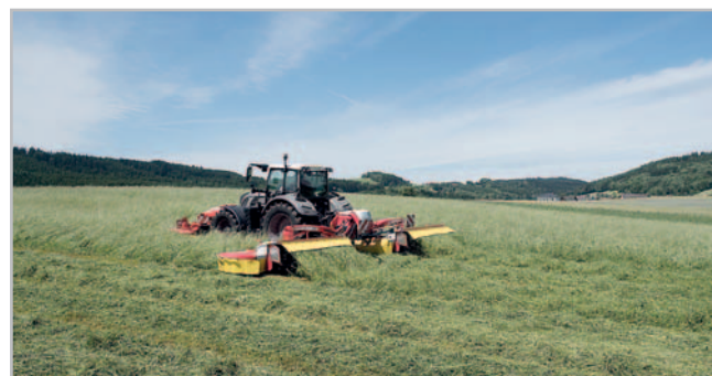
Od jara 2019 pracuje ve VOD Jetřichovec žací kombinace Pöttinger NovaCat A10. Je vybavena hydraulicky ovládaným stranovým posunutím, centrálním mazáním a ovládaním Power Control
