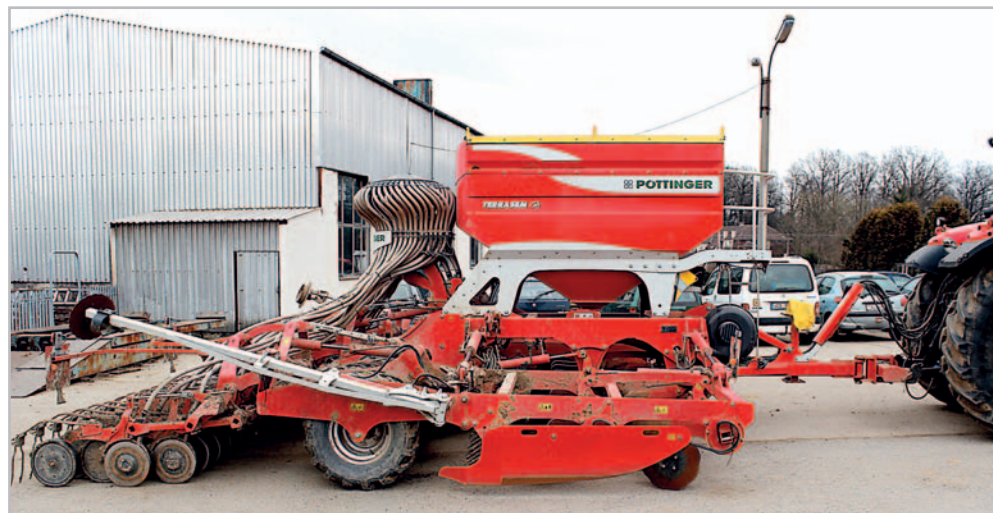
Plynulé kopírování terénu i v největších záběrech až devíti metrů je u secích strojů Terrasem dáno zdalekou koncepcí třídičného rámu – ke středovému rámu jsou výkyvně připojeny stranové sekce
