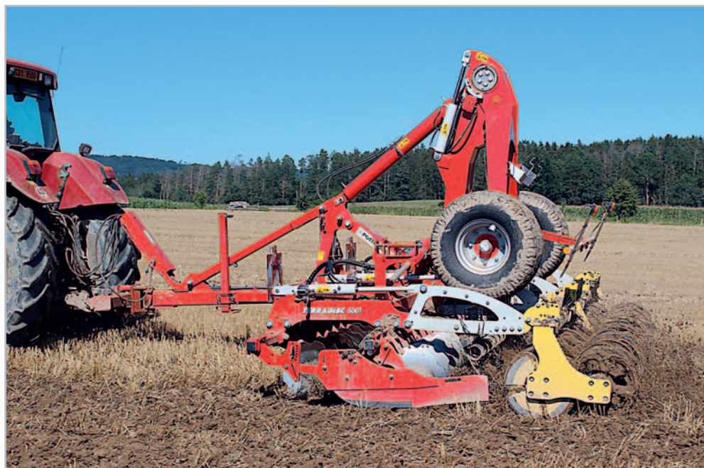
U podmítačů Pöttinger Terradisc T v taženém provedení je v pracovní poloze jejich transportní náprava sklopena nad strojem tak, že dotěžuje pole talířů
