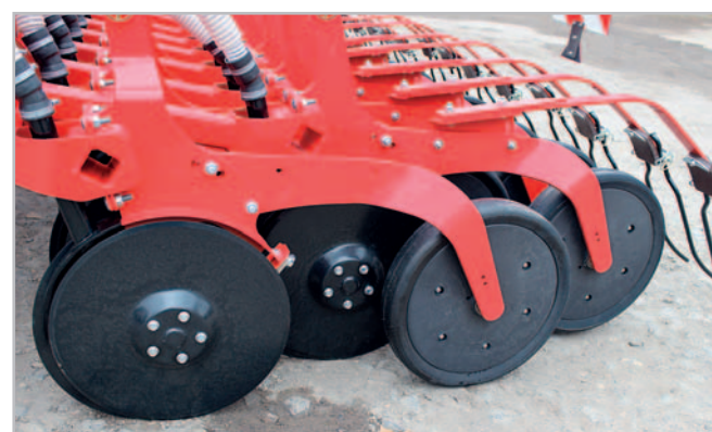
Dvě řady secích botek jsou uloženy v rozteči 320 mm, rozteč secích botek činí tradičních 12,5 cm. Takto je umožněno rovnoměrné uložení osiva do půdy
