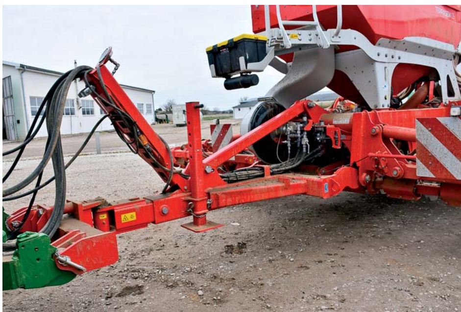
Teleskopicky vysúvateľné oje je výhodné v prípade dvojmontáží, nasávanie pre ventilátor posunul Pöttinger vyššie z dôvodu nižšej prašnosti.
