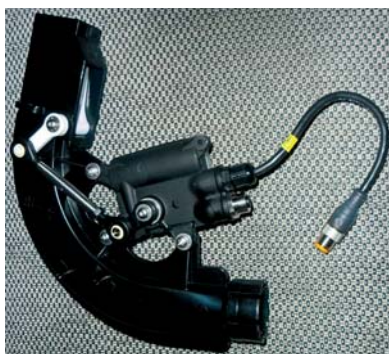
Rozdeľovacia hlava IDS a klapka, ktorá uzatvára jednotlivé semenovody.
