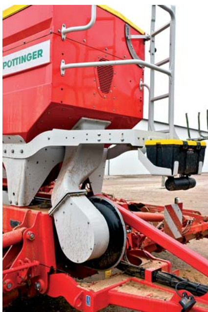
Teleskopicky vysúvateľné oje je výhodné v prípade dvojmontáží, nasávanie pre ventilátor posunul Pöttinger vyššie z dôvodu nižšej prašnosti.
