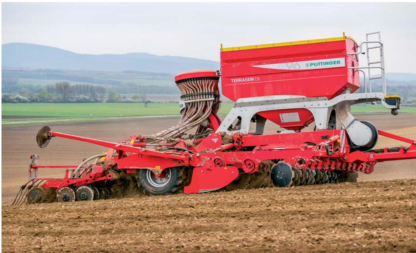
Výrobca ponúka pre pôdoobrábaciú sekciu s 510 mm taniermi aj rôzne urovnávacie smyky a lišty.
