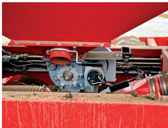
Výsevný valček poháňa elektromotor cez prevodovku, čo zamedzuje pri pomalých otáčkach trhavé pohyby výsevného valčeka.
