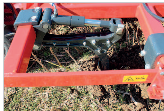
Nový systém nonstop jištění umožňuje vypínací tlak centrálně nastavit a upravit z kabiny traktoru podle potřeby – až na maximální vypínací sílu 6,5 kN
