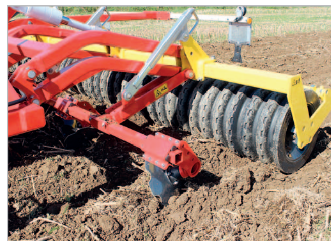
Gumový válec se ukázal v dobrém světle – je odolný vůči kamenům i zalepování
