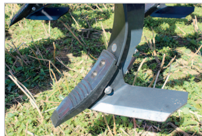
Podle slov mechanizátora vydrží pracovní orgány Durastar Plus, tvořené dráty 80 mm a šipovými radličkami, bez problémů i v kamenitém podloží
