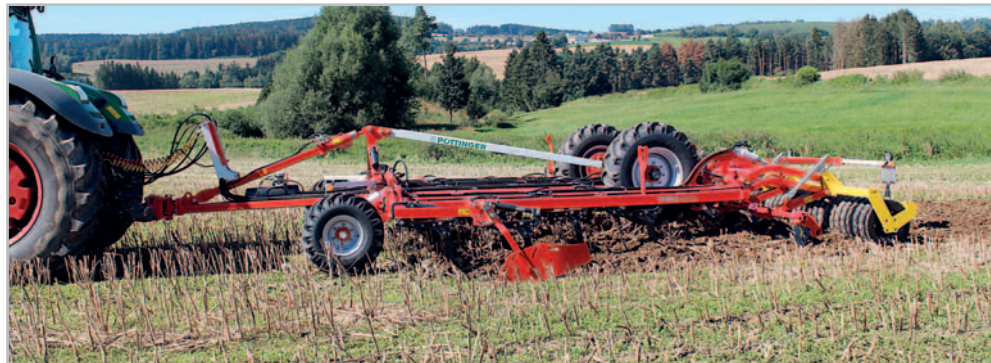
Nejenom k podmínkám, ale především pro přípravu půdy před setím do hloubky 24 cm pod ozimou pšenici a jarní ječmen bude ve VOD Jetřichovec sloužit nový radličkový kypřič Terria 5040 firmy Pöttinger
