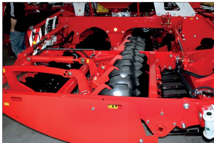
U secího stroje Pöttinger Terrasem C4 provádí přípravu půdy před setím dvě řady talířů o průměru 510 mm. Pracovní hloubka u první řady talířů může být nastavena na jiné úrovni než u druhé řady
