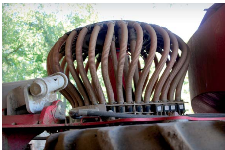
Rozdělovací hlava má 32 vývodů a na přání může být vybavena kontrolou průchodnosti osiva každé semenovodné hadice
