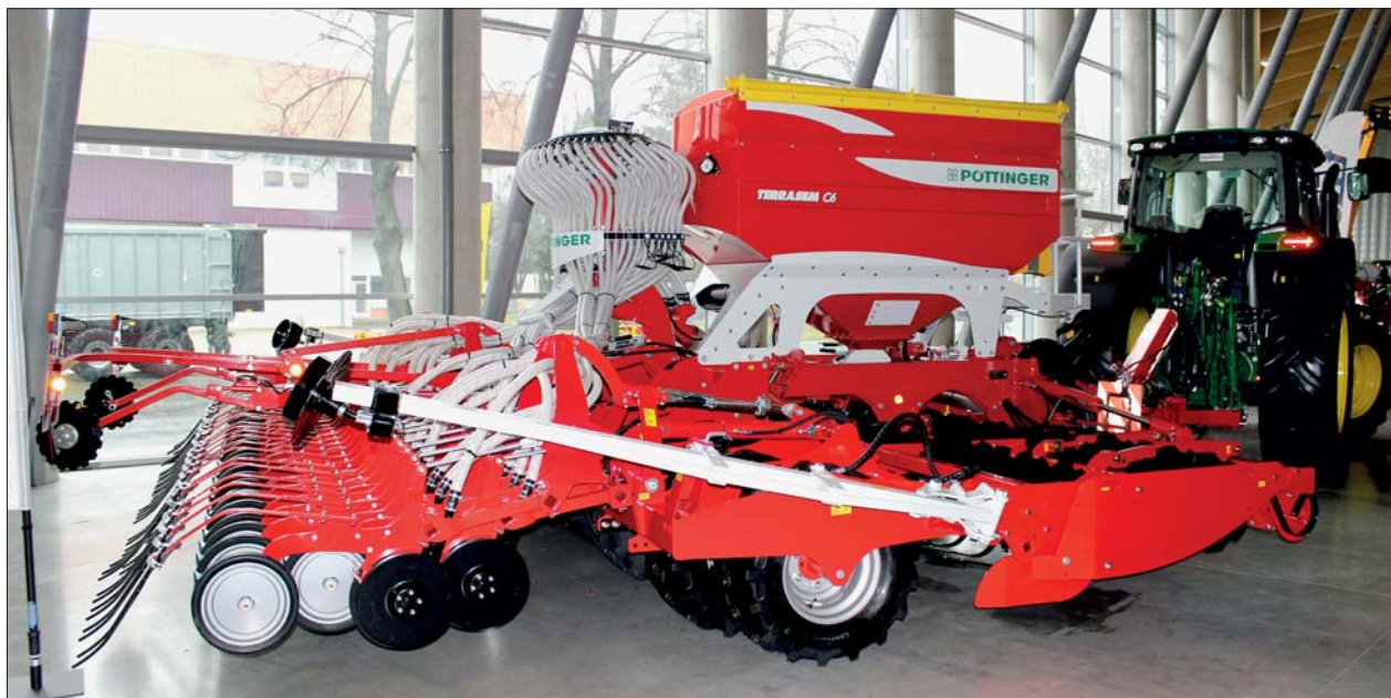
Plynulé kopírování terénu i v největších záběrech až devíti metrů je u secích strojů Terrasem dáno zdařilou koncepcí třídičného rámu – ke středovému rámu jsou výkyvně připojeny stranové sekce
