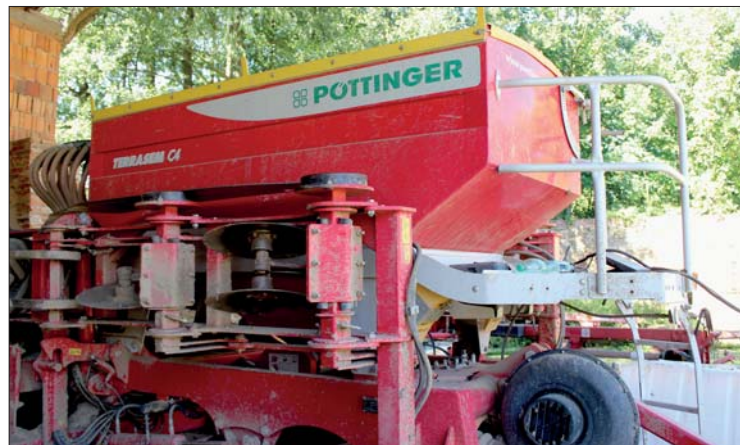
Velkoobjemový zásobník u secího stroje Terrasem C4 pojme standardně 3000 l osiva, s nástavbou pak 4000 l. Široká plošina se zábradlím umožňuje bezpečný přístup k zásobníku, který je uvnitř standardně vybaven roštem proti vnikání cizích předmětů do dávkovacího ústrojí
