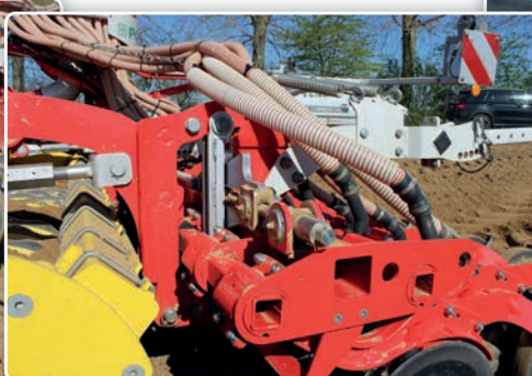
De kouterbalk wordt op de rol geplaatst en volgt de diepteverstelling van de rol.
