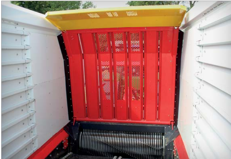
Inteligentní přední stěna je vybavená obzvláště velkou horní kompresní klapkou. Její nastavení se řídí způsobem využití vozu, ale může také přispívat ke zvýšení stlačení hmoty v ložné ploše vozu
