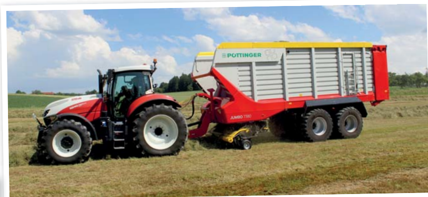
Jumbo 7380 je s 38 krychlovými metry objemu ložné plochy nejmenší model nové řady. Nicméně instalací přídatných plechů k nástavbě je možné objem vozu zvýšit o další dva krychlové metry
