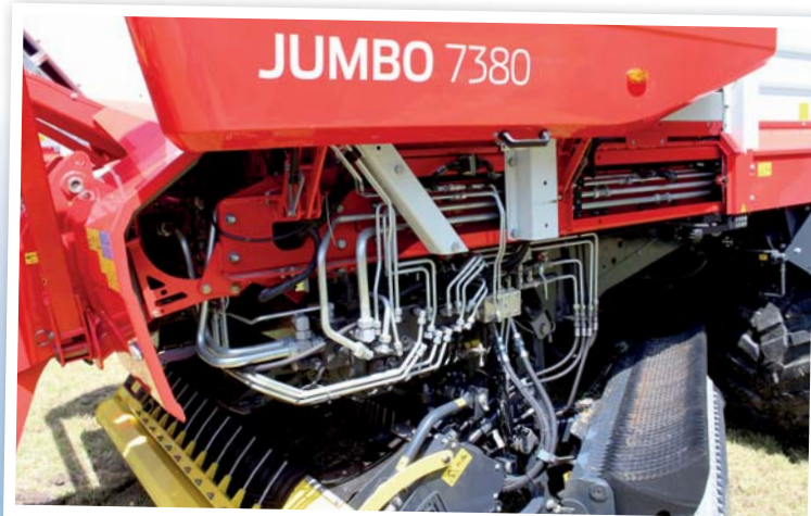
Devadesát procent hydrauliky vozu je soustředěno na jeho levé straně pod nově koncipovaným krytem. Také hydraulika je přepracovaná, nápadné jsou například silné hadice pro vedení oleje k pohonu sběrače
