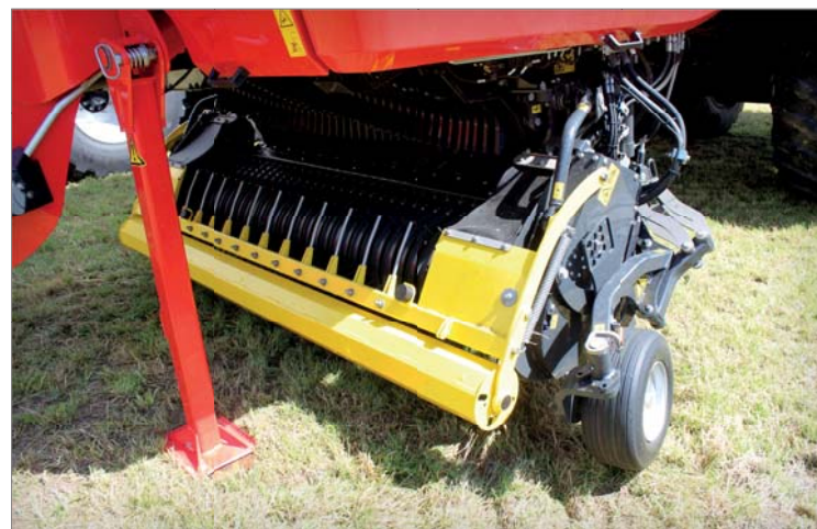
Sedmiřadý řízený sběrač Super Large je široký 2360 mm a zvládne sběr i mohutných řádků. Má možnost příčného výkyvu a pracuje s novými, zesílenými prsty Durastar. Přítlačná pružina na boku zvyšuje tlak plechu na proud přicházející hmoty
