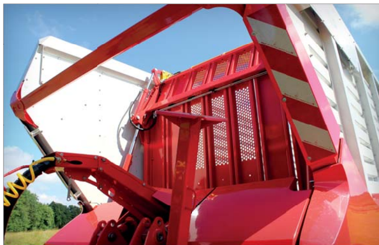
Ve výbavě na přání všech modelů Jumbo 7000 je inteligentní čelní stěna. Svými výkyvy umí zvyšovat úroveň komprese materiálu v ložné ploše, ale i urychlovat vyložení materiálu
