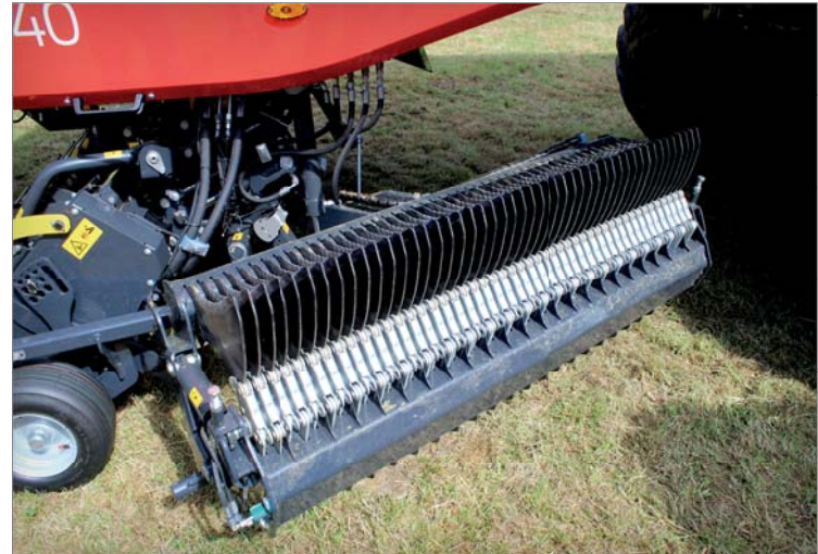
Výklopný nosník Easy Move je osazen 48 noži, čemuž odpovídá řezanka o teoretické délce 34 mm. Nože jsou vyrobeny z kalené nástrojové oceli Durastar
