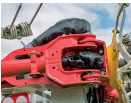
Rotory sú prepojené bezúdržbovými dvojitémi krížovými kĺbmi alebo prstovými spojkami.
