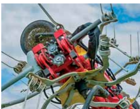
Rotory sú prepojené bezúdržbovými dvojitémi krížovými kĺbmi alebo prstovými spojkami.
