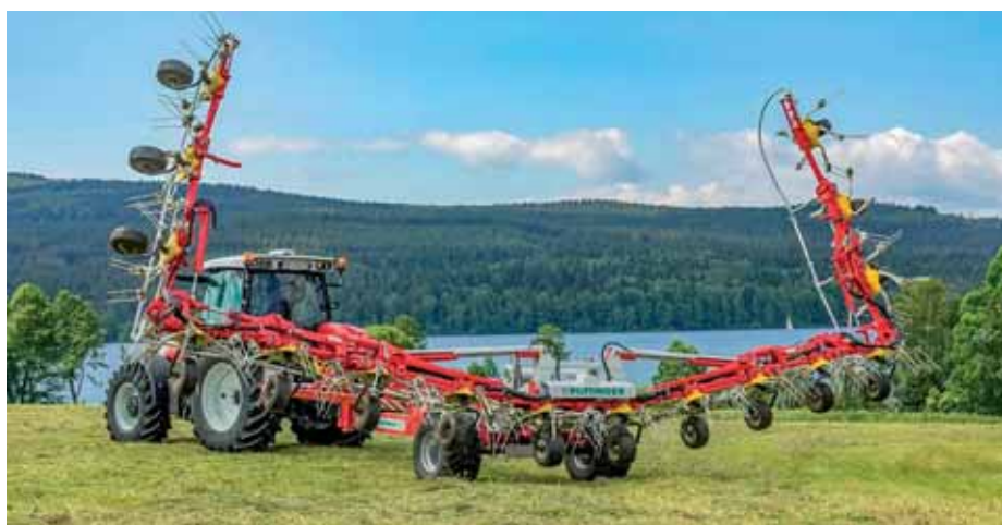
HIT sa rozloží na pracovný záber 17 m iba pomocou dvoch dvojčinných okruhov. Ramená sa počas rozkladania dostávajú nad výšku 4 m, takže treba dávať pozor na elektrické vedenie.
