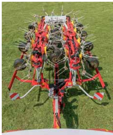
V transportnej pozícii je 16 rotorov zložených kompaktné a s nízkym ťažiskom.
