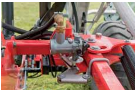
V pracovnej polohe prepína kinematika ventil brzdnej sily na minimálnu brzdnú silu, čím zabráni pri brzdení na lúke blokovaniu transportných kolies.
