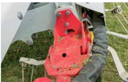
Pripojenie okrajových častí stroja je skonštruované masívnejšie.
