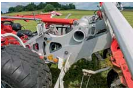
Výška práce sa nastavuje komfortne vretenom. Funkcia Liftmatic je v základnej výbave.
