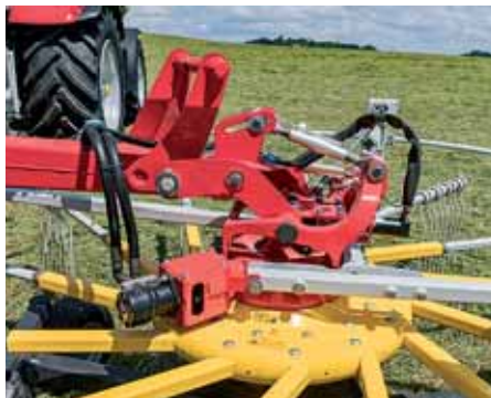
Hydraulický pohon predných rotorov umož- ňuje širokú škálu nastavení rámu.
