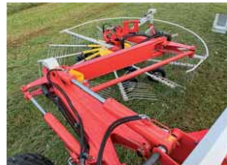
Rám pre rotory zosilnil. Jeden hydraulický piest odľahčuje, druhý zdvíha rotor do úvra- tovej pozície.
