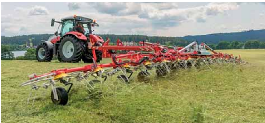
Kopírovanie povrchu nás v kopcovitom teréne milo prekvapilo. Iba 6 zo 16-tich rotorov je párovo pevne prepojených.
