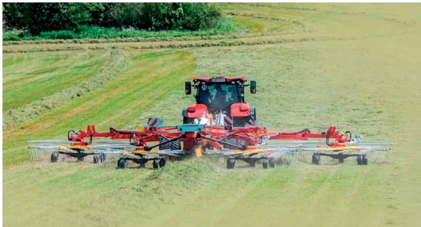
Nový vysokovýkonný zhrabovač Pöttinger sa vyznačuje veľkým priemerom rotorov vpred a senzorikou.
