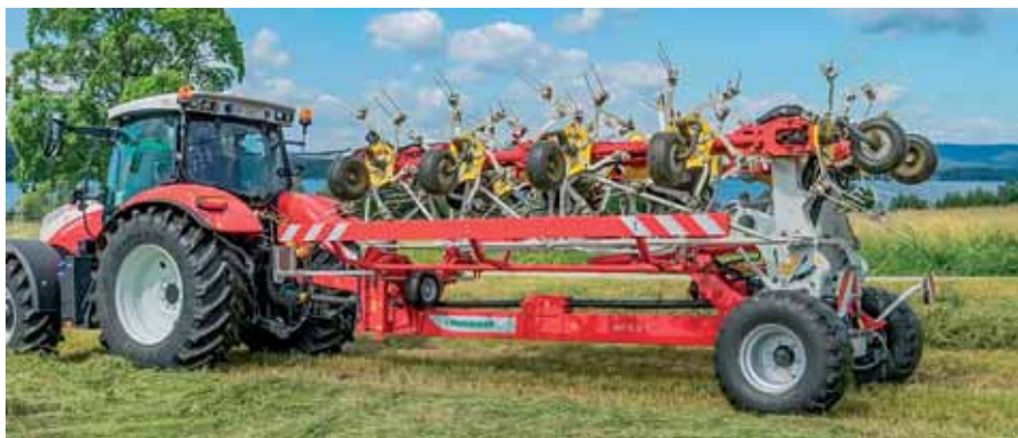
Rám HIT 16.18 T sa zosilnil a zväčšil sa priemer rotorov.
