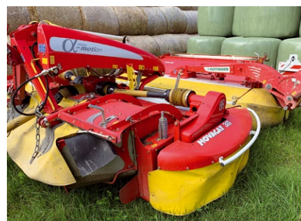
Žací stroje vybavené prstovými lamači – čelní NOVACAT 301 ED ALPHA MOTION a zadní NOVACAT 302 ED – pracují jako kombinace.
