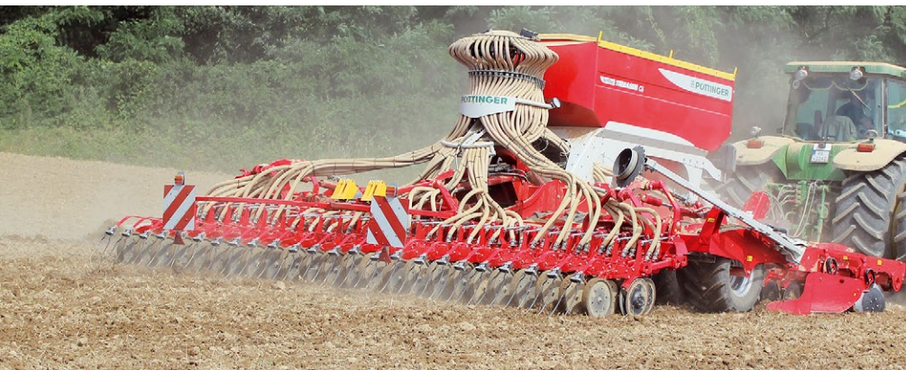
Univerzálny sejací stroj TERRASEM C6 FERTILIZER umožňuje pri jednom prejazde súčasne ukladanie osiva i dávkovanie štartovacej dávky hnojiva. Na farme s ním takto efektívne zakladajú porasty už tretiu sezónu.
