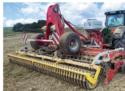
Najnovším strojom na farme MOGBI je šesťmetrový diskový podmietač TERRADISC 6001 T so zariadením na výsev medziplodín TEGOSEM.
