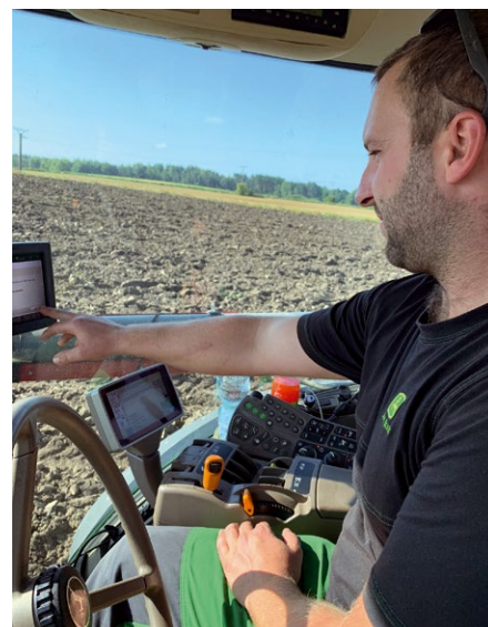
Vladimír Vácha, který s technikou Pöttinger pracuje, nastavuje v daných půdních podmínkách hloubku a přitlak botek pro optimální uložení osiva řepky.
