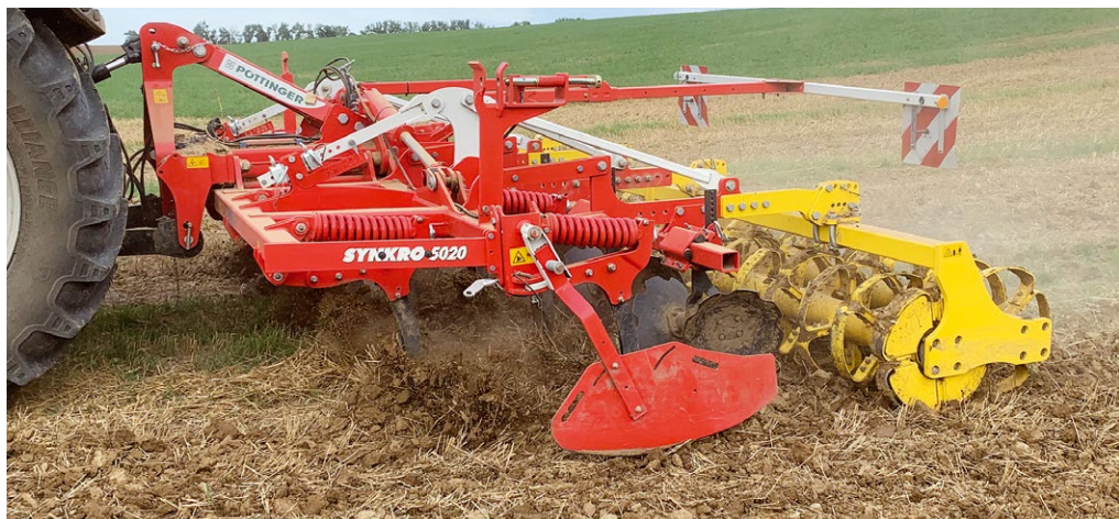
Pětiradličný podmiťáč SYNKRO 5020 K NOVA vybavený NONSTOP jištěním je výborným nástrojem pro intenzivní promíchání rostlinných zbytků po sklizni. Na farmě ho využívají třetí sezonu.
