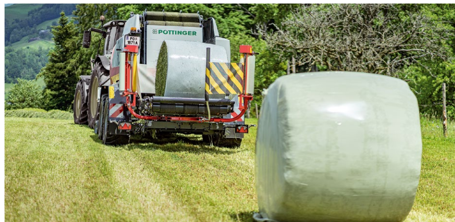
Lis na kulaté balíky IMPRESS 155 VC PRO s integrovanou ovíječkou a fóliovým obvodovým vázáním, představuje úsporu obalového materiálu a zvyšuje kvalitu krmiv. Má variabilní komoru a zvládne dvě operace při jedné jízdě. Vybavený je tandemovou nápravou, řezacím ústrojím s 32 noži a sběračem širokým 2,30 m.
