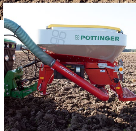
Kombinace rotačních bran LION 403 C a pneumatického secího stroje AEROSEM 4002 FDD s čelním zásobníkem v agregaci s traktorem 245 k při setí ozimé řepky. Tlakový zásobník osiva má objem 1 700 l.
