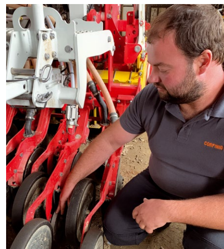
Univerzálním pneumatickým secím strojem AEROSEM 3002 ADD s rotačními bránami LION 303 seje Stanislav Danihel všechny plodiny včetně kukuřice, kterou tento stroj umí set do dvouřádku díky technologii DUPLEX SEED.
