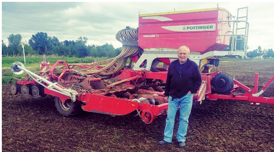
Univerzální secí stroj TERRASEM C6 ARTIS PLUS s pracovním záběrem 6 metrů pracuje v agregaci s traktorem 230 k. Podle Ing. Koubka významně zkrátí čas pracovních operací a přinesl úsporu provozních nákladů.
