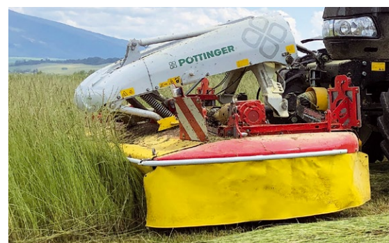
Moderný čelne nesený žací stroj NOVACAT 301 ALPHA MOTION MASTER s pracovným záberom tri metre, má zníženú hmotnosť a originálny skrátaný záves pre perfektné kopírovanie terénu.
