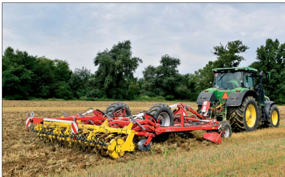
Radličkový kyprič Pöttinger Terra s pracovným záberom 4 metre. Ide o prvý stroj tohto typu dodaný na Slovensko.
