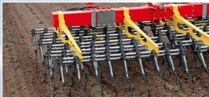
Штригельна борона TINECARE. Кожна грабліна має індивідуальне налаштування за допомогою притискної пружини
