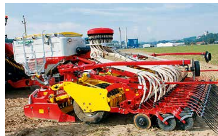
Пневматичний посівний комплекс AEROSEM VT 5000 DD із робочою шириною 5 м придатний для роботи за будь-яких технологій обробки ґрунту з можливістю одночасного висіву насіння та добрив
