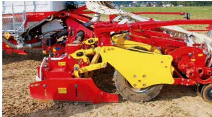
Фронтальний бункер AEROSEM 6002 FDD зручний в обслуговуванні і може мати один або два дозуючі апарати
