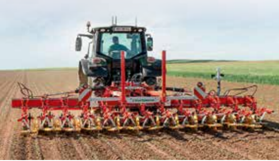
Новий культиватор для просапних культур FLEXCARE можна використовувати для різних культур і за різної ширини міжряддя – від 25 до 160 см
