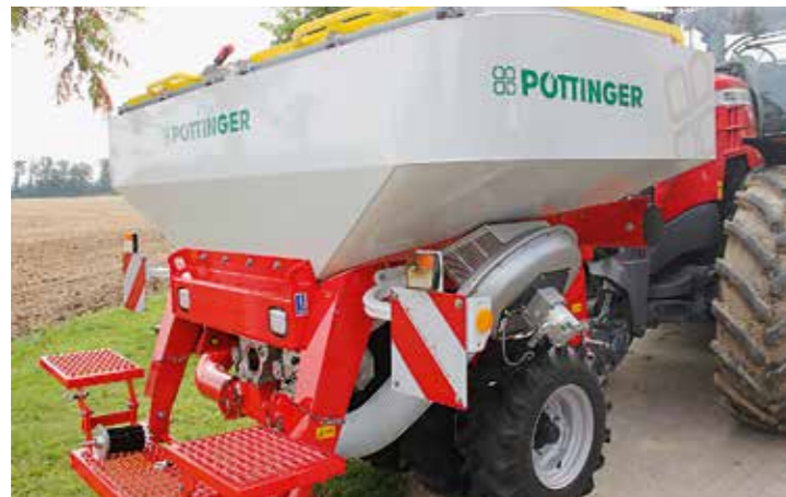
Фронтальний бункер AEROSEM 6002 FDD зручний в обслуговуванні і може мати один або два дозуючі апарати
