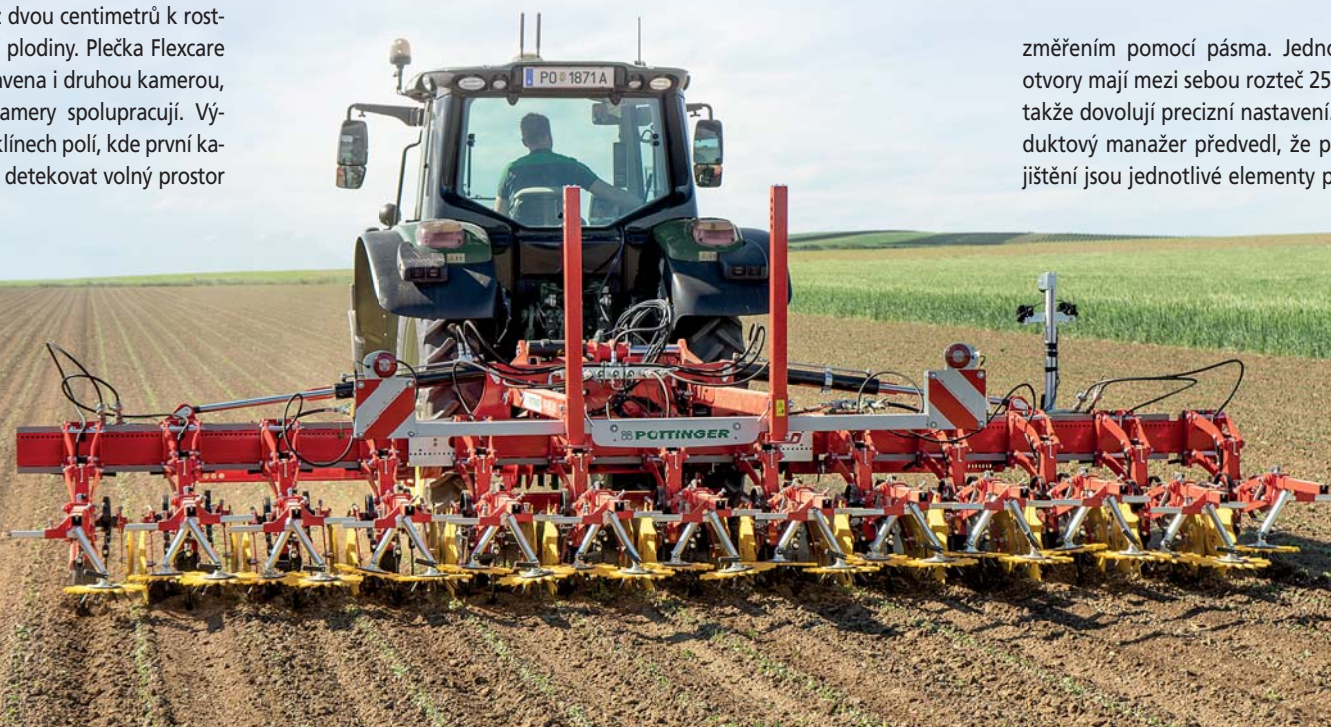
Po doplnění plečky Flexcare o hvězdicová kola je možné eliminovat plevelné rostliny i v řádcích
