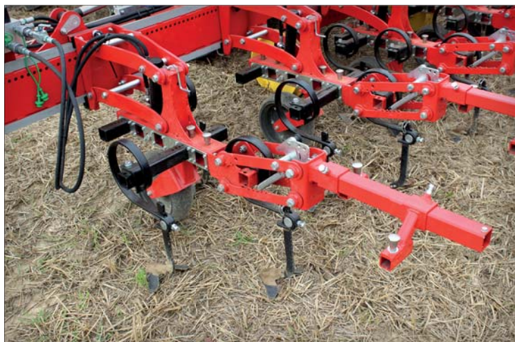
Pleč elementy jsou zavěšeny na paralelogramu. Modulární koncepce dovoluje osazení různými typy radliček
