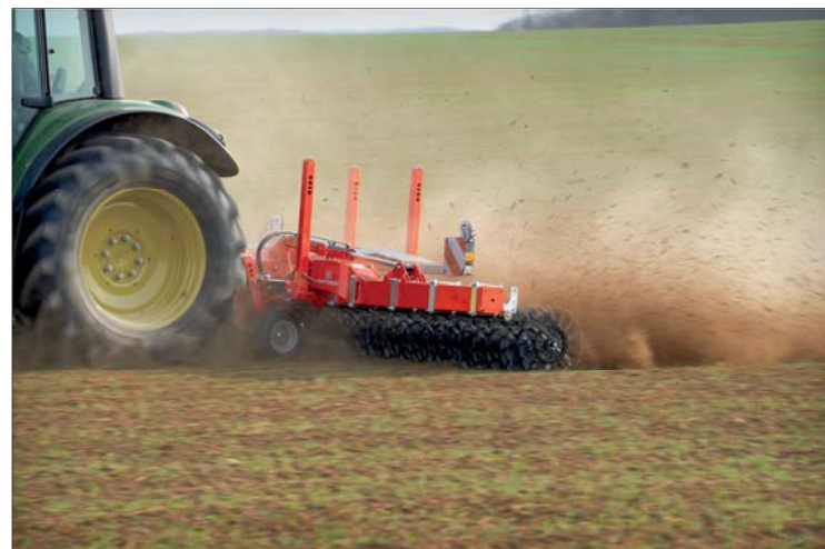
Dostatečná pracovní rychlost – od 15 km/h výše – je podmínkou účinnosti rotační plečky Rotocare
