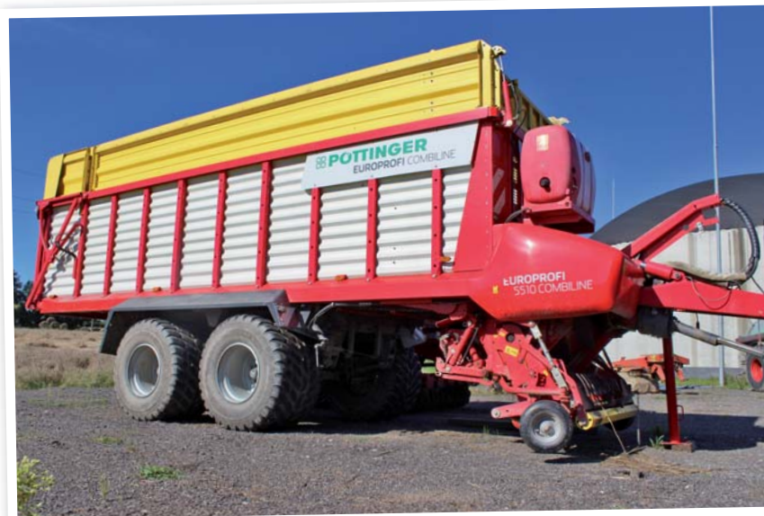
Zcela přesně splnil očekávání majitelů víceúčelový návěs Pöttinger Europrofi 5510 L Combiline. Kromě sběru zavádě hmoty z řádku provádí také odvoz hmoty od sklízecí řezačky. Po dobu pěti let funguje zcela bez poruch
