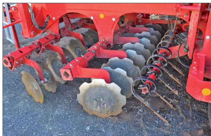
Dvě řady talířů o průměru 510 mm zabezpečují precizní přípravu půdy před setím, a to i při vyšší pracovní rychlosti
