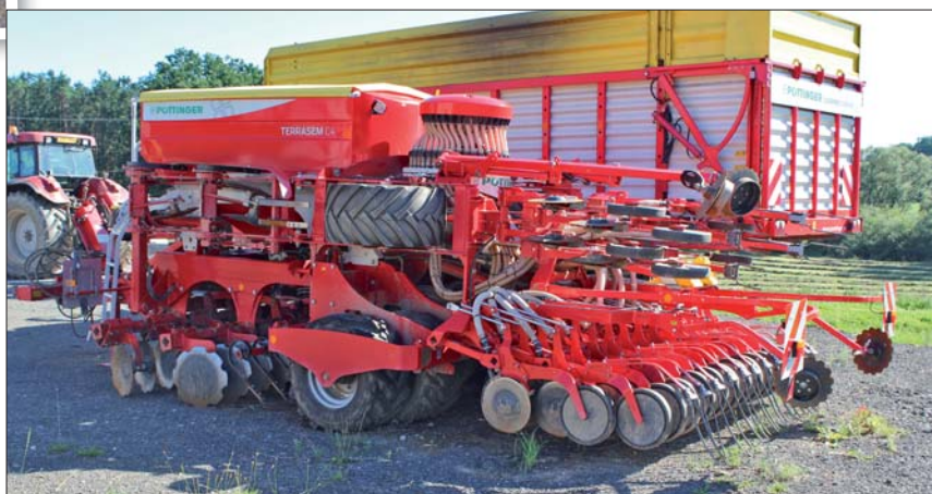
Pneumatický secí stroj Terrasem C4 přinesl na Farmu Basík zvýšení produktivity i zjednodušení práce. Při pracovním záběru čtyř metrů pojme do svého zásobníku 3000 l osiva
