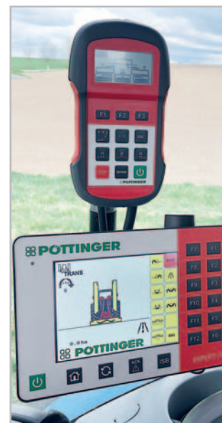
Žací kombinace se ovládá prostřednictvím panelu Expert 75, kde lze mimo jiné také nastavovat úroveň odlehčení a překrytí žacích jednotek nebo intervaly údržby. Pro ovládání systému Sensosafe slouží terminál Select Control, u kterého lze v závislosti na podmínkách sklizně nastavit citlivost systému ve třiceti úrovních. Select Control opticky i akusticky signalizuje, která jednotka detekovala zvěř
