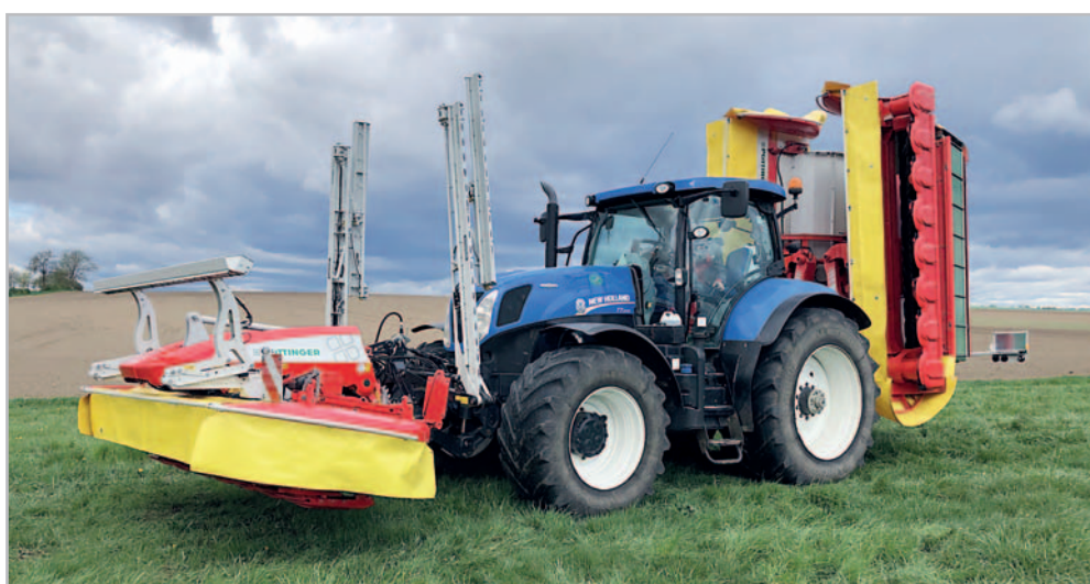
V přepravní poloze systém Sensosafe nijak výrazně nenarušuje výhled z traktoru
