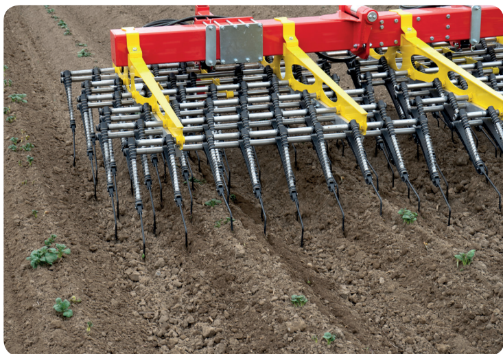
Prutové brány Tinecare V s patentovaným systémem pružinového jištění
