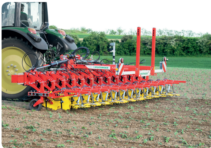
Radličkové plečky Flexcare V lze využívat pro kultivaci v celé řadě plodin s meziřádkovou vzdáleností od 25 do 160 cm
