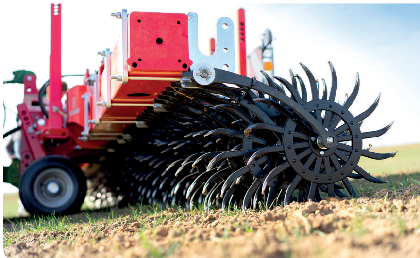
Hvězdice rotační plečky Rotocare V jsou osazeny 16 samoostřícími hroty lžícovitého tvaru z tvrdokovu
