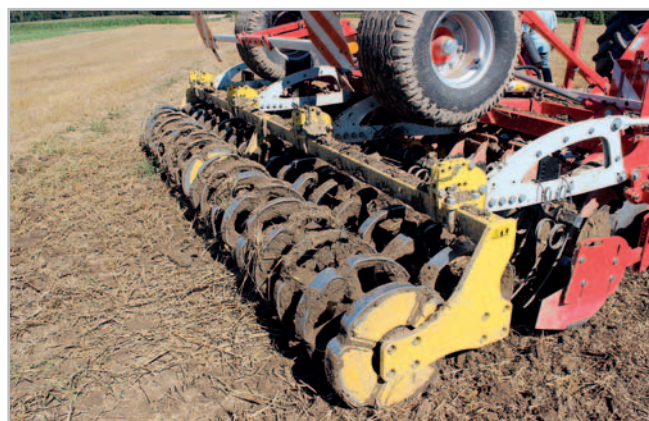
Segmentový válec Tandem Conoroll je tvořen dvěma válci s tandemovým uspořádáním, kdy každý válec zpracovává polovinu pracovního záběru. Velká nosnost je výhodou této varianty opěrného válce Foto Petr Beneš
