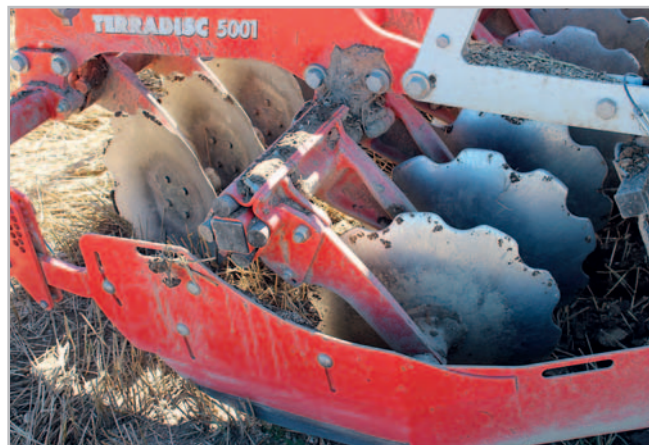
Otevřený rám a způsob uchycení slupic k rámu poskytují dostatek prostoru, díky čemuž má Terradisc velmi dobrou průchodnost pro organickou hmotu Foto Petr Beneš
