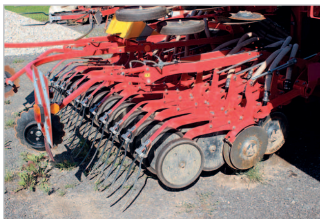
Ramena secích botek jsou koncipována tak, že první i druhá řada mají shodný přítlak. Přítlačná kolečka zabezpečují přesné hloubkové vedení, přítlačení osiva do půdy a uzavření výsevních rýh Foto Petr Beneš
