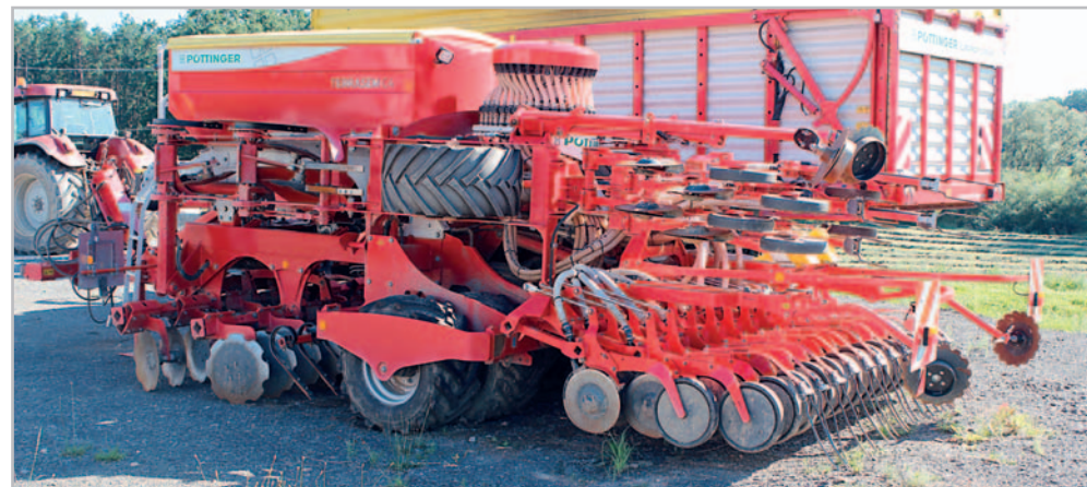
Pneumatický secí stroj Terrasem C4 přinesl na Farmu Basík zvýšení produktivity i zjednodušení práce. Při pracovním záběru čtyř metrů pojme do svého zásobníku 3000 l osiva Foto Petr Beneš
