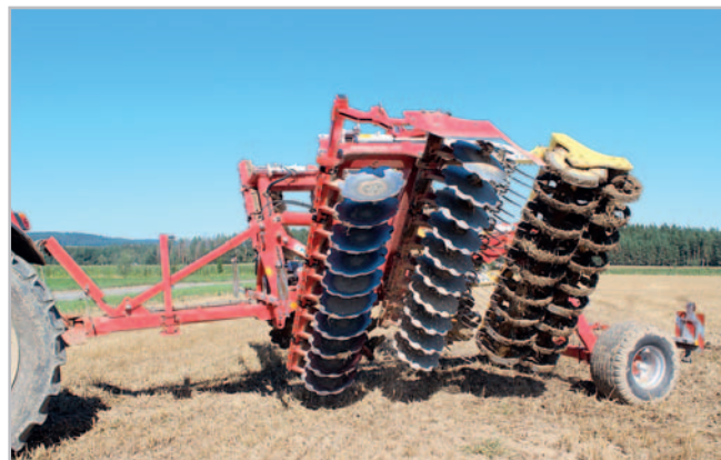
Talíře ve dvou řadách u podmiťáče Terradisc 5001 T firmy Pöttinger zanechávají rovnoměrný horizont zpracování s účinným promícháním. O urovnání půdy před opěrnými válci se stará sekce prutů Foto Petr Beneš
