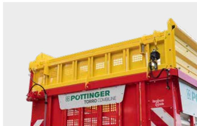
První snímač v přední stěně měří při vlhké a těžké trávě tlak plnění a ovládá podlahový dopravník.
