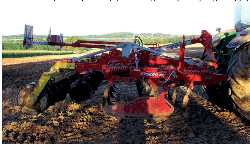
Radličkový kypřič Synkro 4030 K Nova slouží na Farmě Hejlov především ke kypření do větších hloubek. Třínosníkové uspořádání pracovních orgánů přispívá k homogenizaci rozložení slámy v půdním profilu
