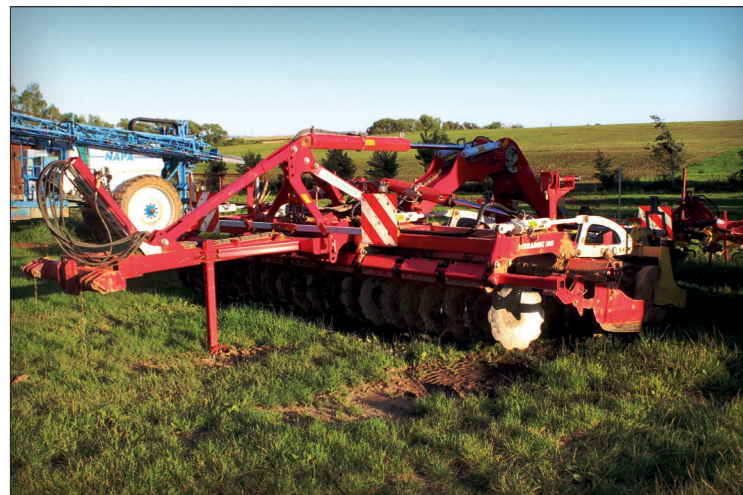
Talířový podmiťáč Terradisc 5001 T v poloneseném provedení se záběrem pěti metrů se vhodně uplatňuje nejen při podmiťkách, ale i při zpracovávání porostů meziplodin
