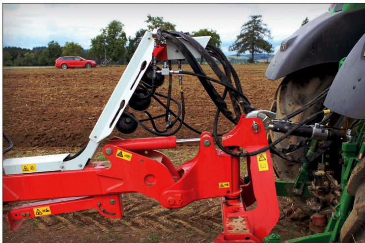
Systém Traction Control na pluhu Pöttinger Servo 6.50 dotěžuje zadní nápravu traktoru přidavnou hmotností. Je řízený – při vyorání pluhu na souvratí je tlak v systému automaticky snížen a po zaorání opět zvýšen
