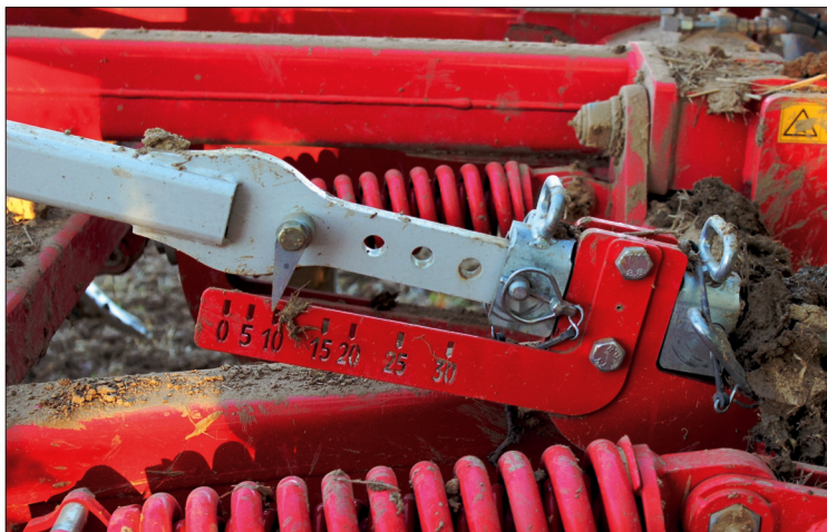
Na dobře přístupném místě, v přední části kypřiče Synkro 4030 K Nova, se nachází nastavování pracovní hloubky. Nechybí ani přehledná stupnice
