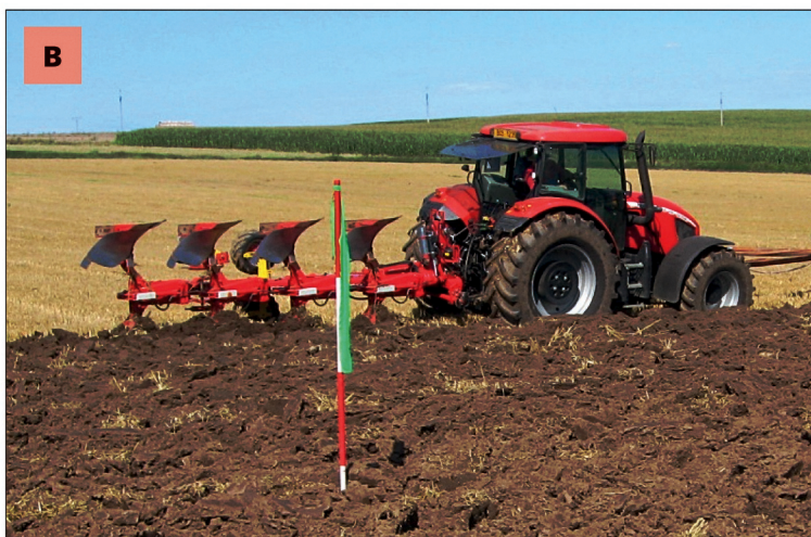
Obr. 1 – Měřené orební soupravy, traktor Zetor Forterra 150 HD s pluhem Pöttinger Servo 45 M Plus s páskovou odhrnovačkou (A) a Pluh Pöttinger Servo 45 M Plus NOVA s plnou odhrnovačkou (B)
