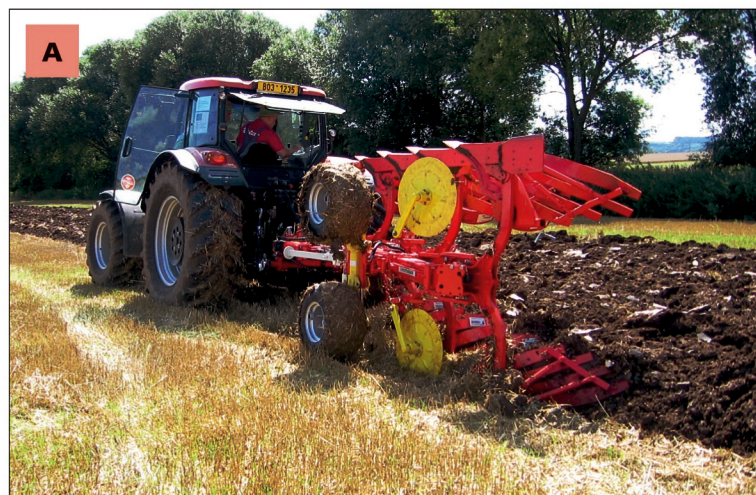
Obr. 1 – Měřené orební soupravy, traktor Zetor Forterra 150 HD s pluhem Pöttinger Servo 45 M Plus s páskovou odhrnovačkou (A) a Pluh Pöttinger Servo 45 M Plus NOVA s plnou odhrnovačkou (B)
