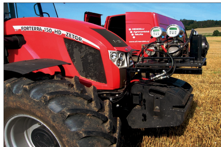
Obr. 4 – Hmotnostní průtokoměry paliva Coriolis Sitrans FC MassFlo Mass 6000 (Siemens) s chladičem paliva
