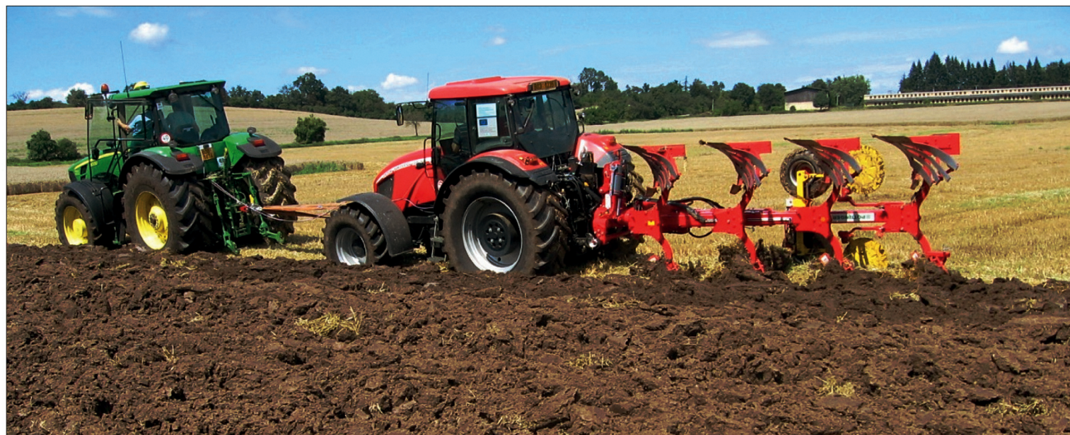
Obr. 5 – Měření tahového odporu orební soupravy
