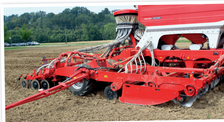
Základní osvědčený koncept zůstává zachován: příprava půdy talíři, zformování seťového lůžka pneumatikovým válcem a setí. Provedení Terrasem fertilizer je vybaveno řadou botek za sekci talířů
