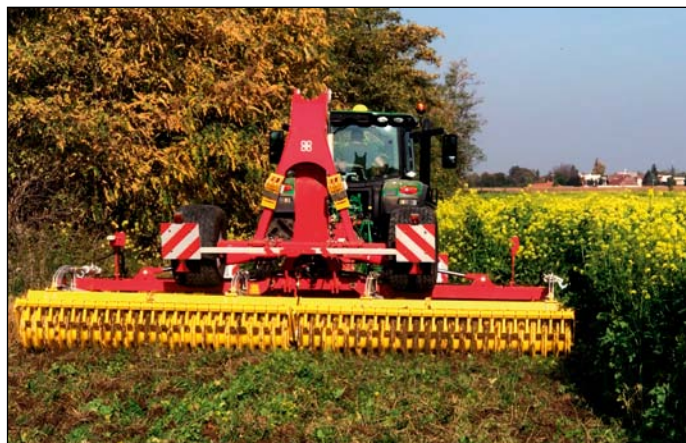
Pri práci sa prepravné kolesá a náprava presunú nad pracovné časti stroja, čo zvyšuje celkovú stabilitu.
