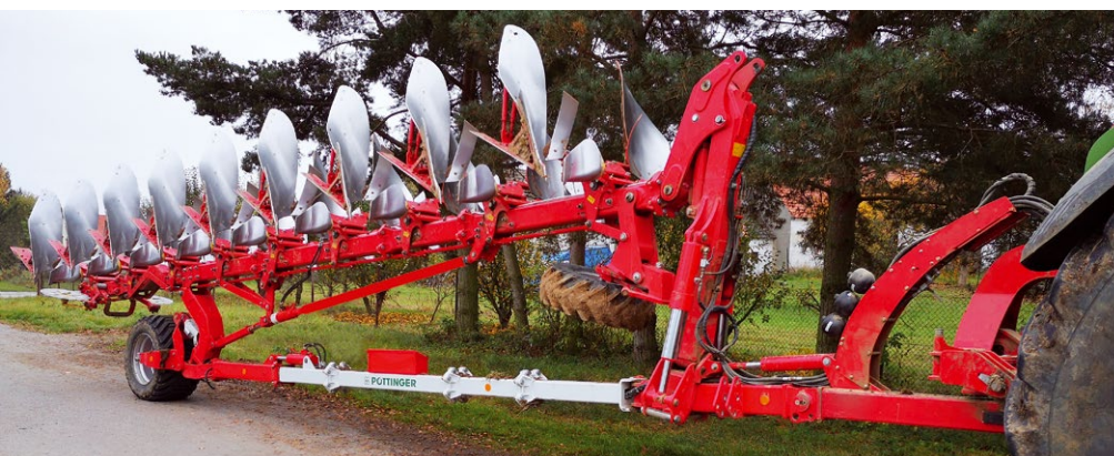
V plánu mají v K+K Břilice pořídit další pluh, tentokrát osmiradličný polonesený otočný SERVO T 6000 PLUS NOVA s automatickým dotěžováním zadní nápravy traktoru systémem TRACTION CONTROL.
