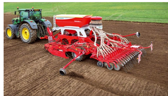
Univerzální secí stroj TERRASEM C4 ARTIS seje kromě kukuřice všechny plodiny včetně zakládání porostů vojtěšky, například po žitě do strniště, nebo přívěvy travních porostů.
