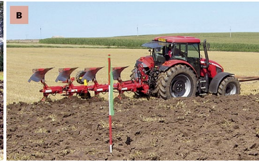
Měřené orební soupravy, traktor Zetor Forterra 150 HD s pluhem Pöttinger SERVO 45 M PLUS s páskovou odhrnovačkou (A) a pluh Pöttinger SERVO 45 M PLUS NOVA s plnou odhrnovačkou (B).
