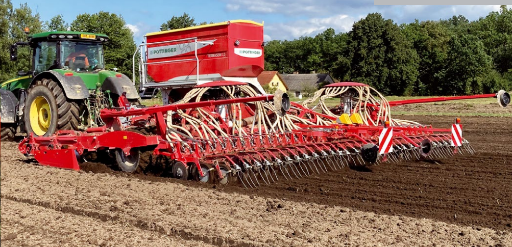
Univerzální secí stroj TERRASEM C8 je promyšleným konceptem. S dvouřadým diskovým podmiřáčem, pneumatikovým válcem a nosníkem botek spojuje kroky předsetové přípravy půdy, tvorby setového lůžka, uložení osiva a zpětného utužení. Záběr má osm metrů a pracuje v agregaci s traktorem 370 k s navigací.
