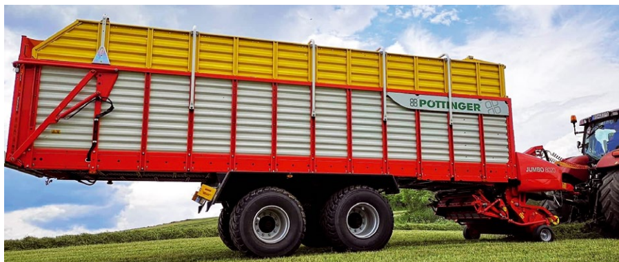
Univerzálny senážny voz JUMBO 8020 L s valcovým vkladacím ústrojenstvom má vysokú výkonnosť a prevádzkovú spoľahlivosť vo všetkých podmienkach pri nižšej spotrebe nafty. V Preňčove zahájil tento rok tretiu sezónu.
