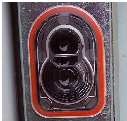
Senzory na základě barevného spektra vyhodnocují hnědou nebo zelenou barvu, jen optický princip, ne žádná detekce tělesné teploty. Na základě podmínek sklizně a ze zkušeností obsluhy lze vybrat ze třiceti stupňů citlivosti.
