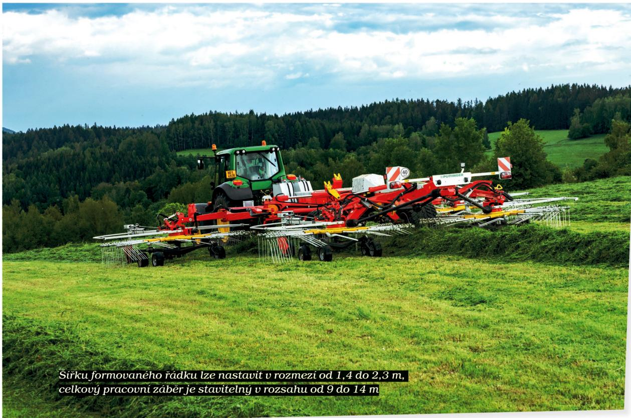
**Šířku formovaného řádku lze nastavit v rozmezí od 1,4 do 2,3 m, celkový pracovní záběr je stavitelný v rozsahu od 9 do 14 m**
