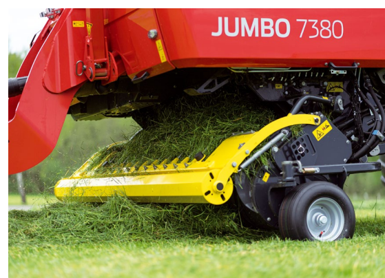
Aktivně řízený sběrač byl inovovaný o hydraulický pohon pro možnost regulace otáček.
