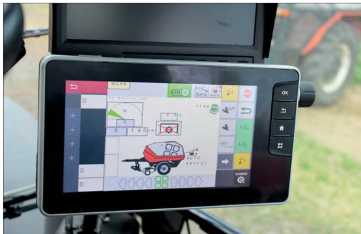
K ovládání lisu Impress 155 V Pro prostřednictvím systému ISOBUS slouží terminál traktoru. Značné ulehčení řidiči přináší automatický režim práce
