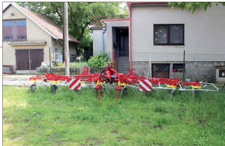
U velkého modelu nesených obrabečů HIT 8.81 s osmi rotory si majitel pochvaluje lehký a tichý chod, dobře propracované kopírování terénu a snadné skládání
