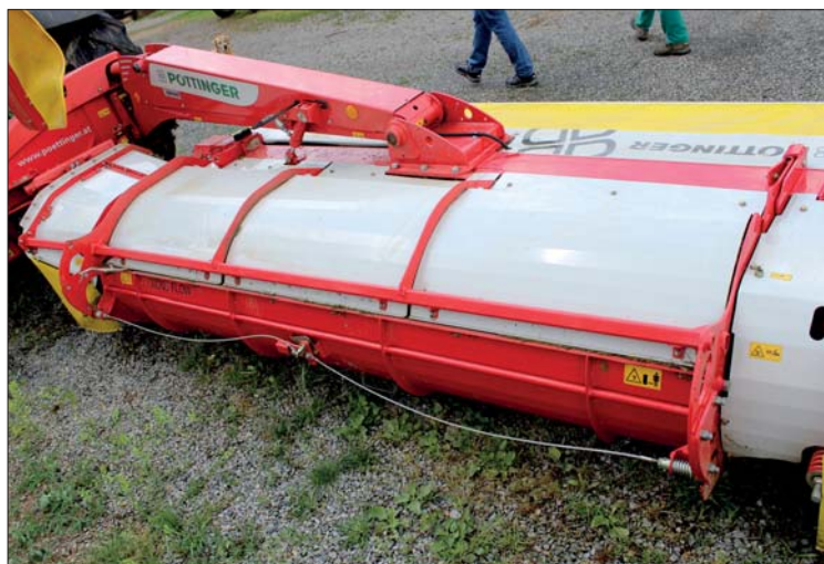
V uzavřené poloze krytu šnekového dopravníku Cross Flow je píce odebírána přímo od žacích disků a transportována na středový řádek. Kryt lze ale také odklopit a hmotu ukládat na široko
