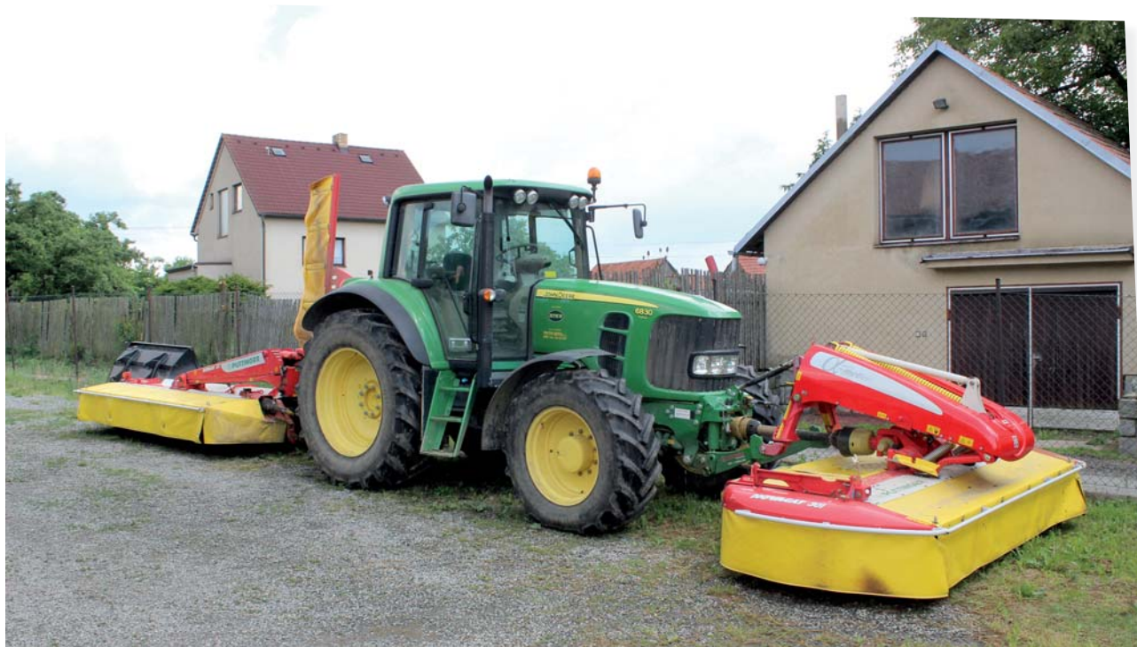
Díky šnekovému dopravníku Cross Flow dokáže tato souprava traktoru John Deere 6830 Premium a dvou žacích strojů NovaCat ze dvou jízd posekat a do jednoho řádku uložit hmotu ze záběru devíti metrů
