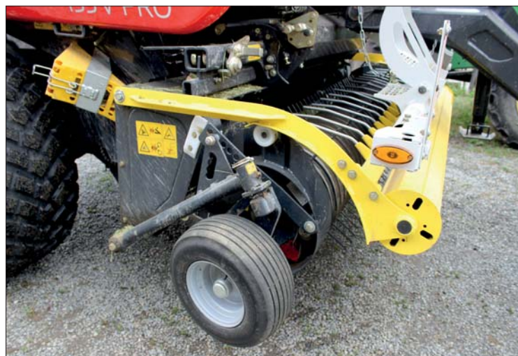
Lis Impress 155 V Pro je vybaven sběračem o šířce 2,3 m. Povrch pozemku může sběrač plynule kopírovat díky nastavitelným opěrným kolečkům a možnosti příčného výkyvu v rozsahu až 120 milimetrů
