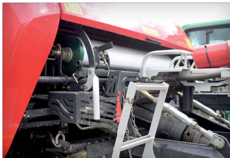
Lis Pöttinger Impress 155 V Pro využívá síť o maximální šířce 130 cm. Miroslav Trčka si oblíbil automatický režim zahájení vázání. Jakmile zazní signál naplnění komory, dojde také k řízenému zvednutí sběrače
